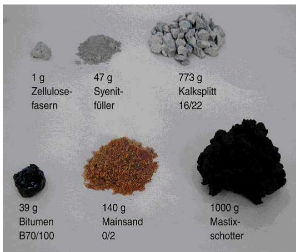
Bild 15.1: Rezeptur des Mastix-Schotters
