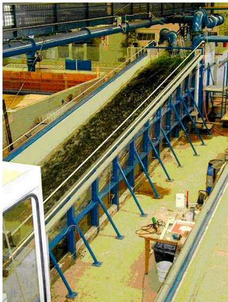
Bild 15.7: Halbdamm-Modell zur Durchführung von Überströmungsversuchen mit einer Böschungsneigung von 1 : 6 während des Betriebes
