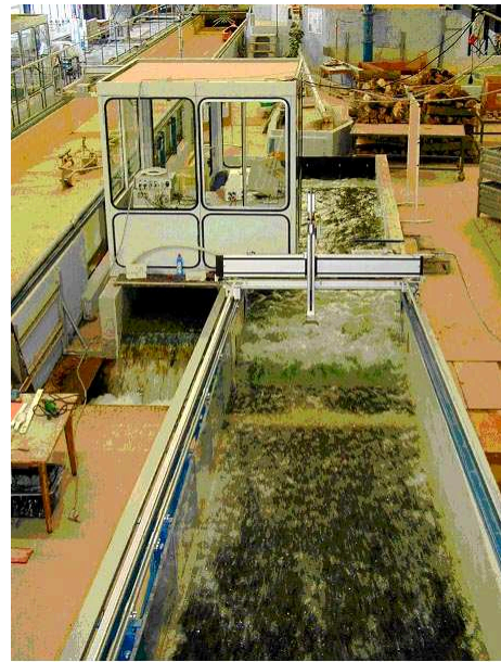
Bild 15.8: Energieumwandlung am Böschungsfuß – Blick von oberstrom /Bieberstein et al. 2002/
