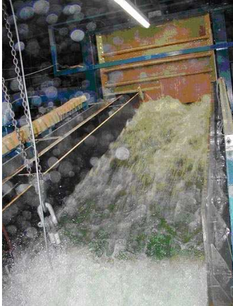
Bild 15.6: Kipprinne – Selbsttragendes Deckwerk aus Mastix-Schotter bei einer Belastung von q = 360 \text{ l/(sm)} bei einer Böschungsneigung von 1: 5
