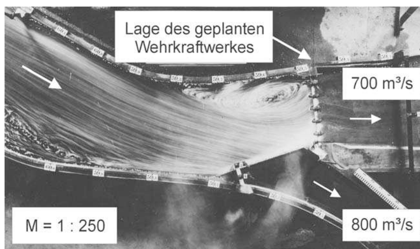
Abbildung 1: Strömungsverhältnisse an der Wehranlage RADAG im Modellversuch von 1932 (Foto: Rehbock)
