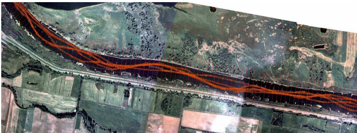
Abbildung 7 Nautisch optimierte Fahrrinnen aus 5 unabhängigen Modellversuchen (Variante V0)
