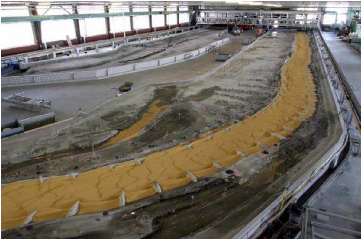
Abbildung 2 Übersicht über das Modell; im Hintergrund die Messbrücke; Fließrichtung von oben nach unten
