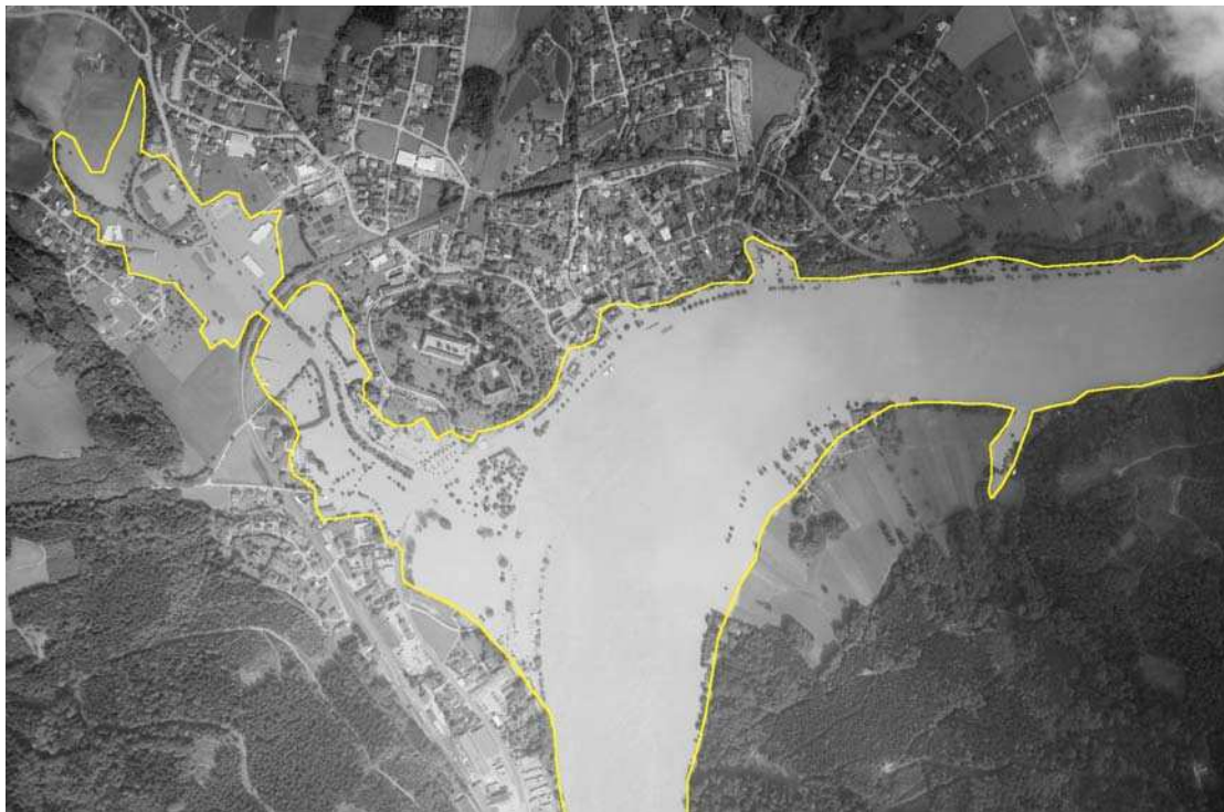
Abbildung 3 Luftbild des Überflutungsgebiets vom 14. August 2002 mit eingetragener Hochwasseranschlagslinie (nach BEV (2002), modifiziert)
