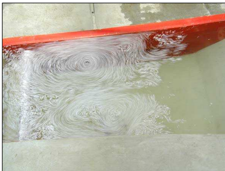
Abbildung 4 Im Laborversuch beobachtete Oberflächenströmung im Einlaufbauwerk (Zeitrafferaufnahme; Belichtungszeit: 2 Sekunden)
