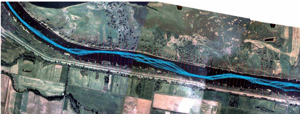
Abbildung 8 Nautisch optimierte Fahrrinnen aus 5 unabhängigen Modellversuchen (Variante V2a)
