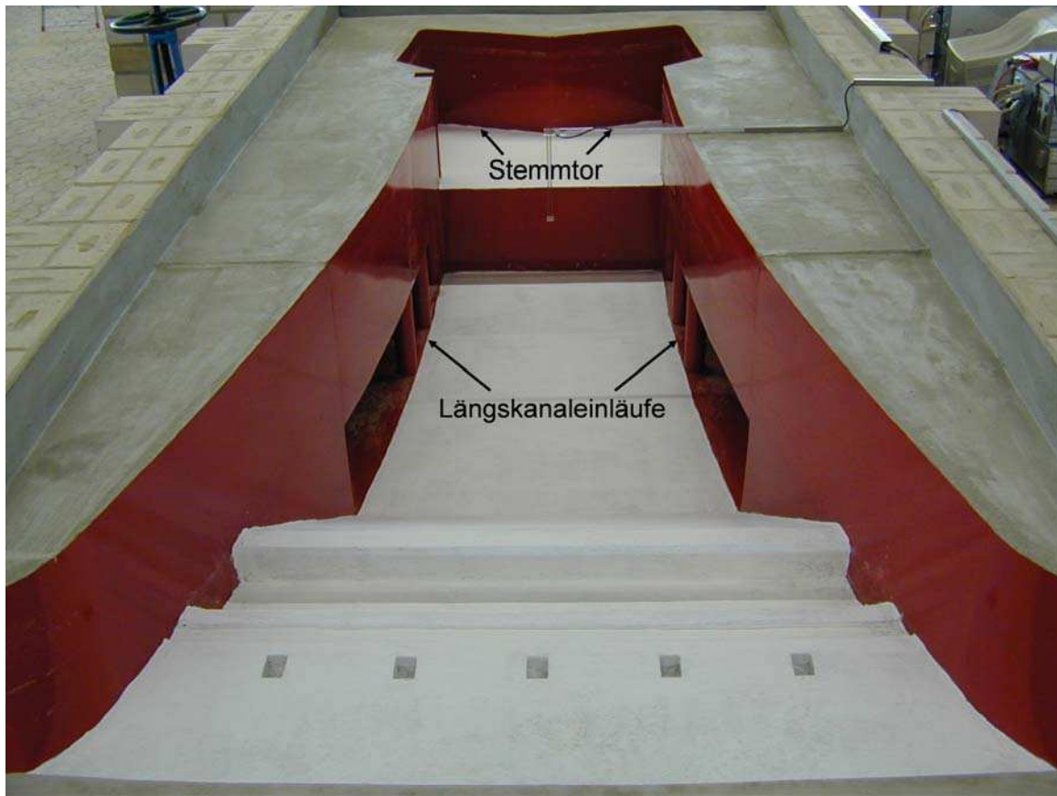
Abbildung 1 Detailansicht des Labormodells in der Versuchshalle des Leichtweiß-Instituts für Wasserbau der TU Braunschweig; Blick in Fließrichtung
