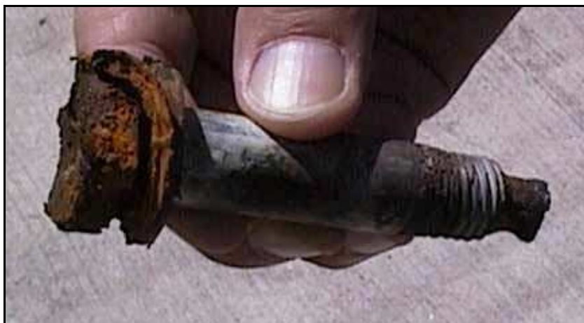
Bild 11: Abrostungen an einer verzinkten Schraube
