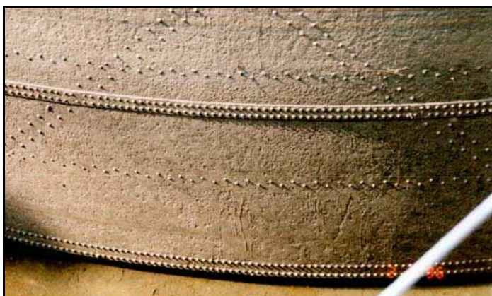
Bild 3a: Narben- / Muldenkorrosion
