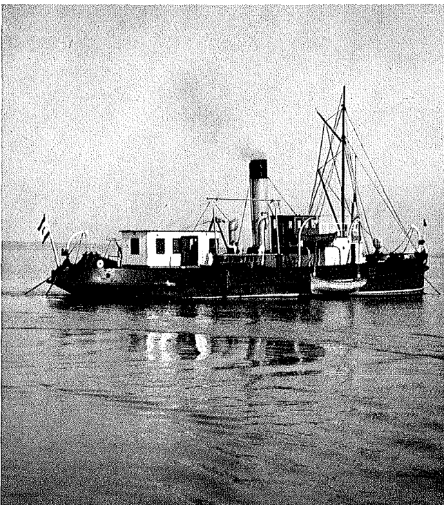
Abb. 11. Meßdampfer „Rungholt“ mit Meßkajüte auf dem Achterdeck auf Position vor 4 Ankern liegend. Bildarchiv Westküste B — a 51 Aufn. E. G. Haberstroh
