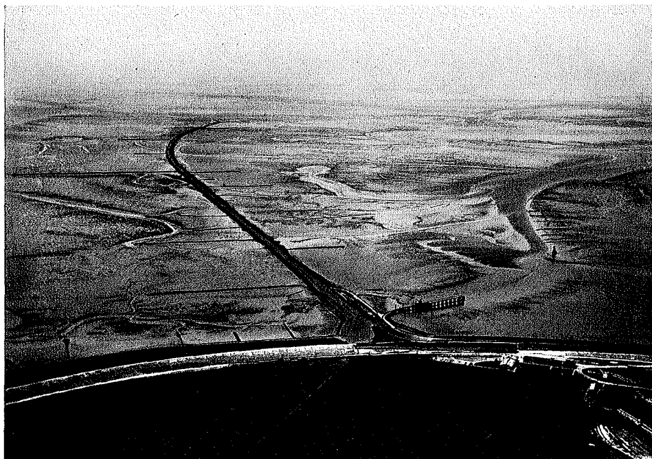
Abb. 21. Damm vor der Friedrichskoogspitze nach der Fertigstellung. Der linke (südl.) Teil des abgedämmten Altfelder Priels ist versandet. Rechts: ein 1935 am tiefen Priel errichteter Pegeldalben, der bei T n w. jetzt bereits trocken fällt.
