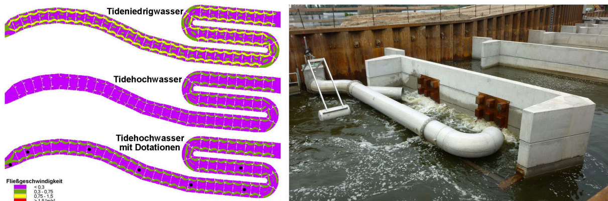
Abbildung 3: Fließkorridor in der FAA bei unterschiedlichen Randbedingungen (links) und Dotationselement nach Realisierung in Natur (rechts)
