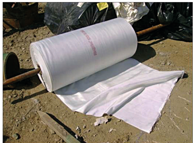
Bild 4: Typische gewebte nahtlose Ummantelung so wie zur Baustelle geliefert vor dem Einbau
