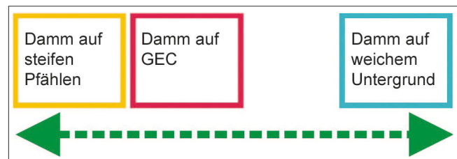
Bild 10: Positionierung des GEC-Systems zwischen zwei Extrema: Dämme auf steifen Elementen und Dämme ohne jegliche Stützung
