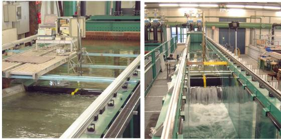
Figure 1: Modèles physiques au laboratoire du BAW a) barrage complet à l'échelle 1:12,5 ; b) section d'un barrage à l'échelle 1:5
