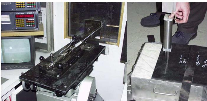
Figure 7: Essais de résistance aux balles et au percement par l'Autorité de contrôle des Armes à Feu à Ulm
