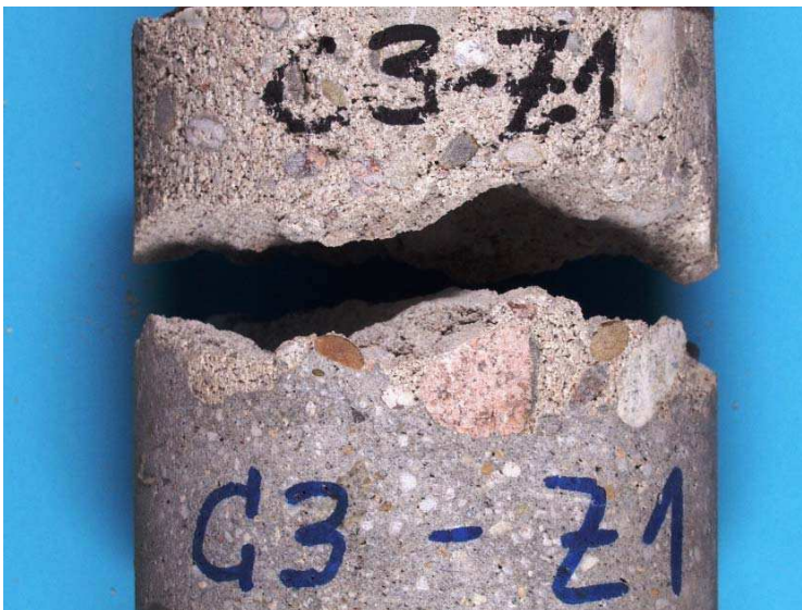
Bild 2: Bruchbild Verbundprobe SPCC 2 nach der Zugprüfung
