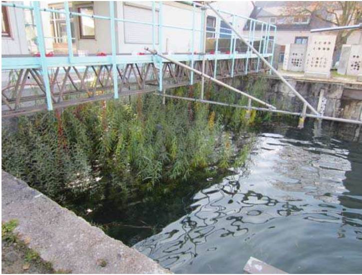
Bild 2: Weidenspreitlage im eingestauten Wellenbecken nach 5 Monaten Anwuchsdauer
