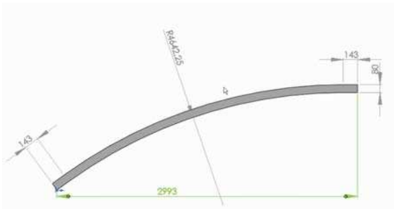
Bild 1: Bauraumgerechte Gestaltung der Torflügelform
