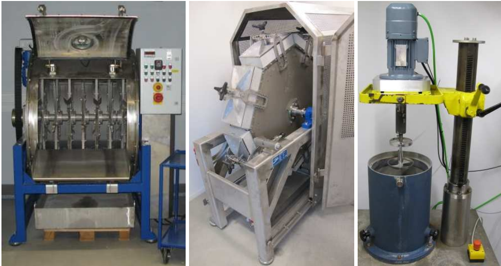
Bild 1: Links: Verschleißtrommel nach [Bania, A., 1989] und [Vogel, M., Müller, H.S., 2009], mittig: Plattenabrasionstrommel, rechts: Prüfeinrichtung nach [ASTM, (2010)].
