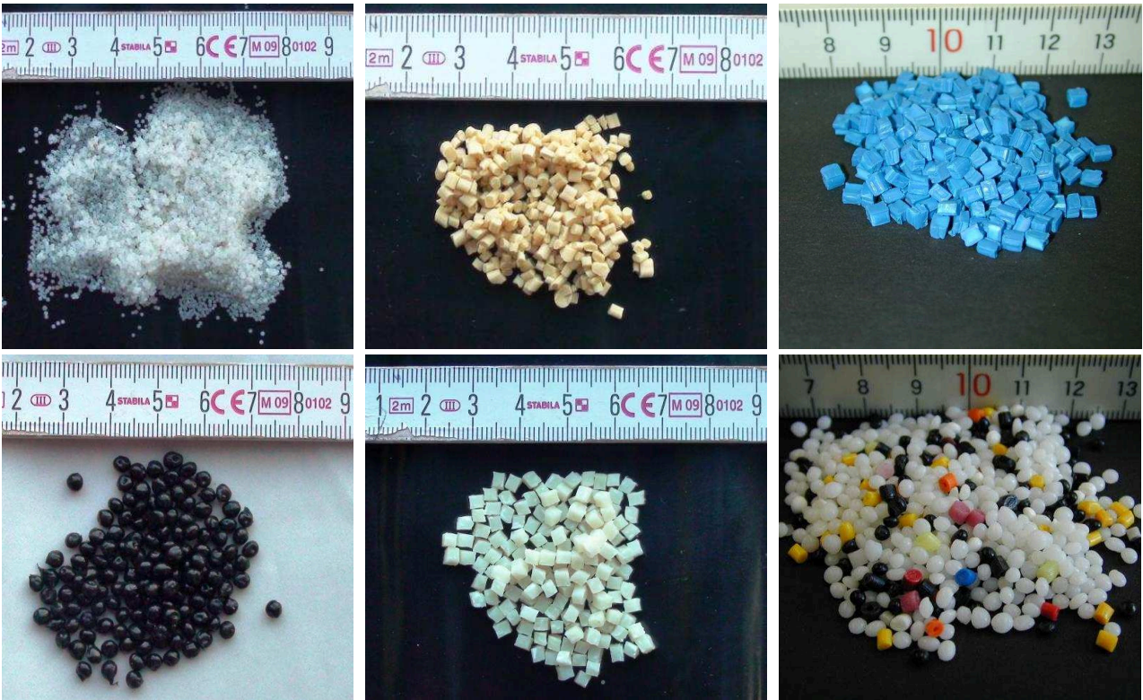
Bild 3: Polystyrol weiß, D^* = \text{rd. } 6 (oben links), Polystyrol gelb, D^*_{50} = \text{rd. } 15 (oben mitte), Granulat blau, D^* = \text{rd. } 18 (oben rechts), Granulat schwarz, D^* = \text{rd. } 22 (unten links), Novodur gelb, D^* = \text{rd. } 28 (unten Mitte), Acetalharz, D^* = \text{rd. } 36 (unten rechts).
