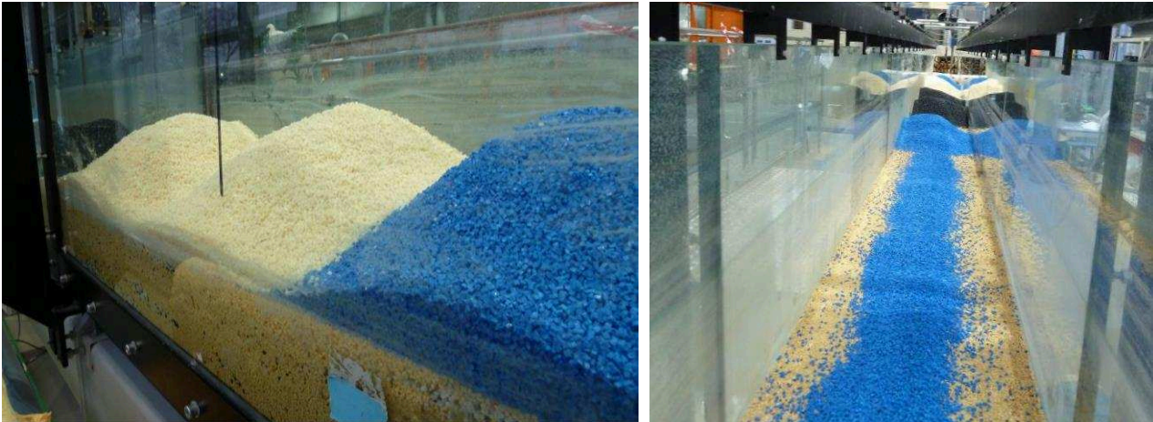
Bild 4: Hydraulische Versuchsrinne mit Kunststoffgranulat-Einzelfraktionen (links) und eingemischten Einzelfraktionen (rechts).
