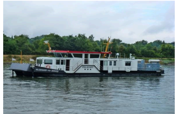
Bild 2: Fächerecholotpeilung mit Peilschiff
