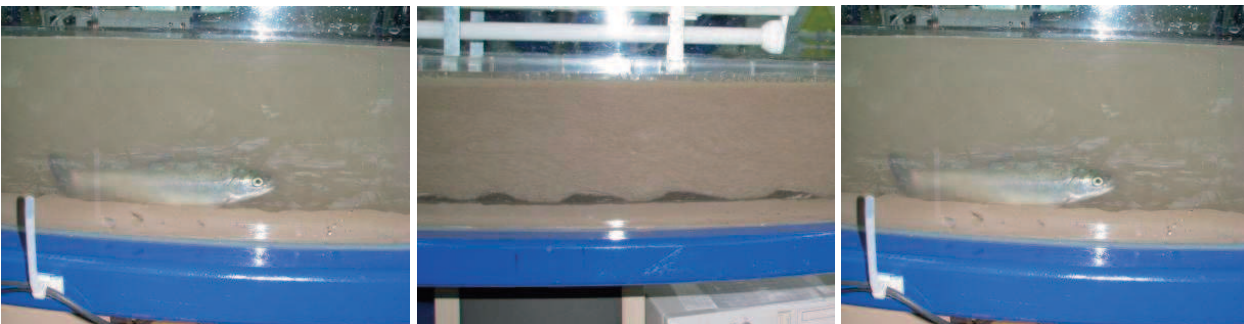
Abbildung 12: Entwicklung der Sohle bei Fischbesatz: a) Versuchsbeginn \tau = 0,0 \text{ N/m}^2 , b) maximale Belastung \tau = 0,3 \text{ N/m}^2 , c) Versuchsende \tau = 0,1 \text{ N/m}^2
