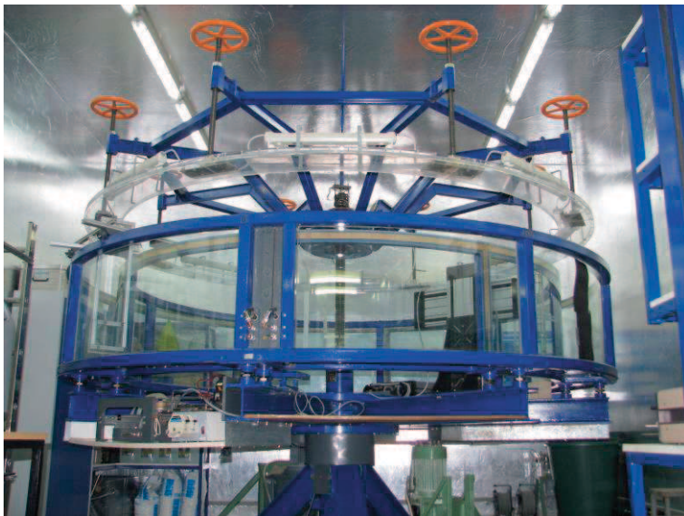
Abbildung 1: Das Kreisgerinne in der Klimakammer am IWW
