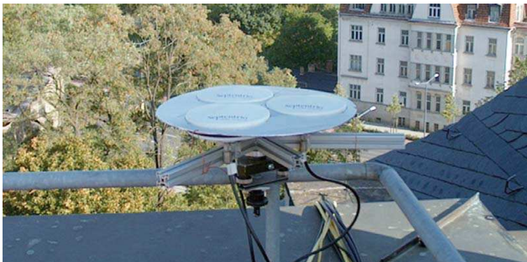
Abb. 9: Entwickelter Antennenprototyp zur Verringerung des Mehrwegeinflusses auf Referenzstationen
