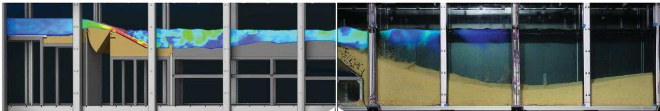
Bild 1: Gegenständliches Modell der Kolkuntersuchungen an der Wehranlage Geesthacht mit eingebundenen numerischen Ergebnissen.
