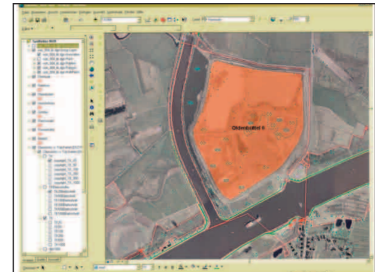
Abb. 3: Als Datengrundlage dienen hierzu die Geodaten der Digitalen Bundeswasserstraßenkarte 1 : 2000 (DBWK2) und die Digitalen Orthophotos (DOP) der Landesvermessung.
