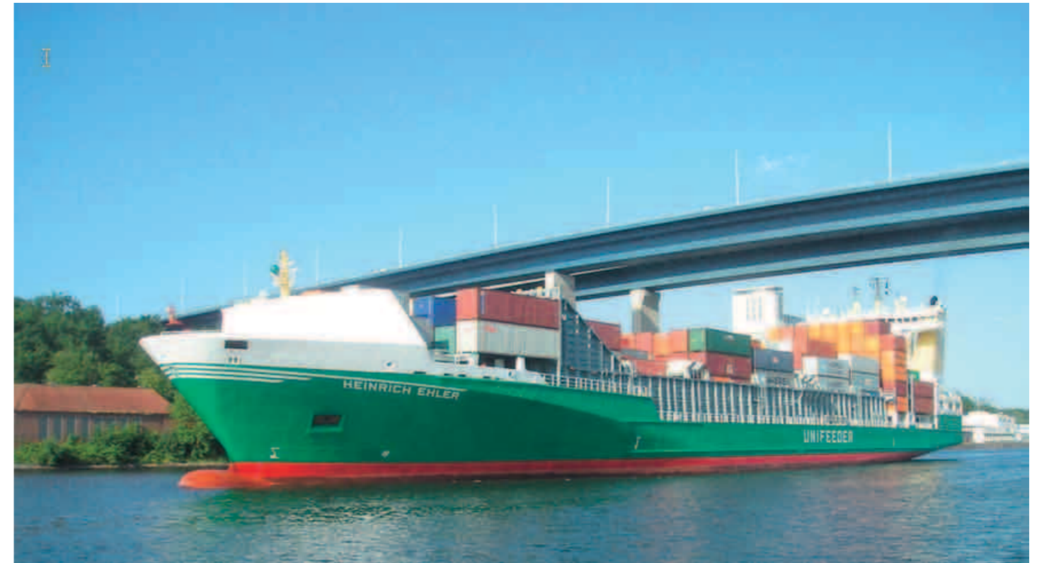
Abb. 5: Container-Feederschiff HEINRICH EHLER 17.488 BRZ 1.440 TEU
