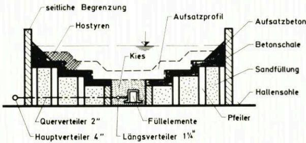
Abb. 6. Modellteil mit beweglicher Sohle (schematisch)
