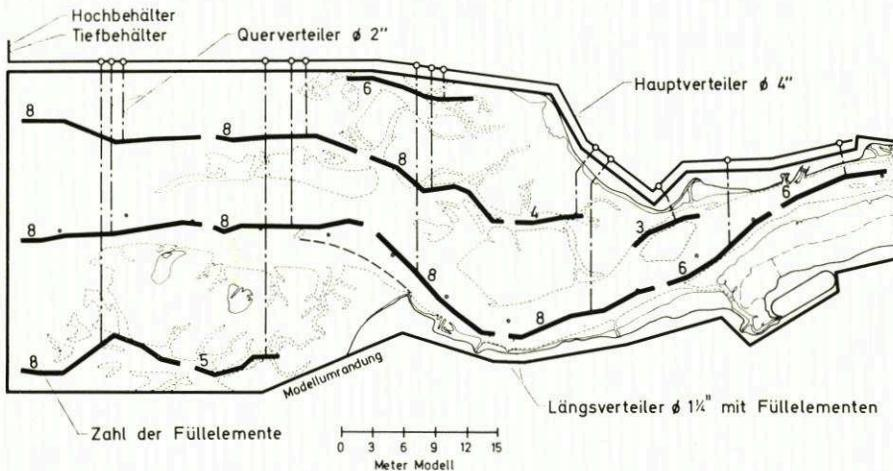
Abb. 7. Verteilernetz für die flächenhaft wirkende Be- und Entwässerung
