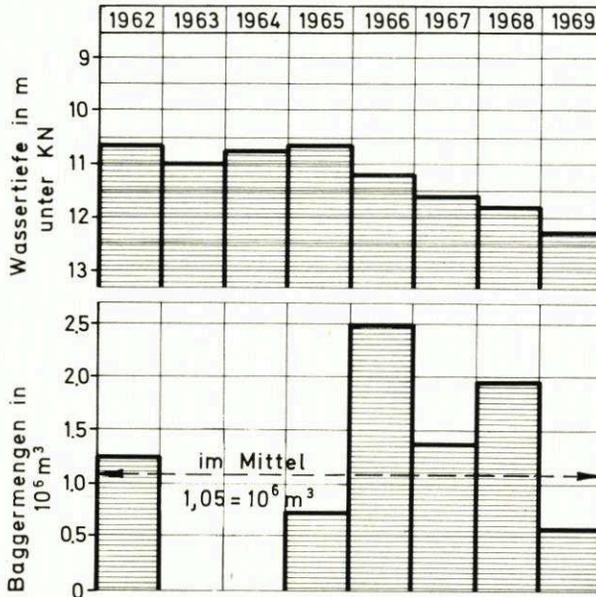
Abb. 14. Entwicklung der mittleren Wassertiefe in Bezug zu den Baggerungen in der Natur
