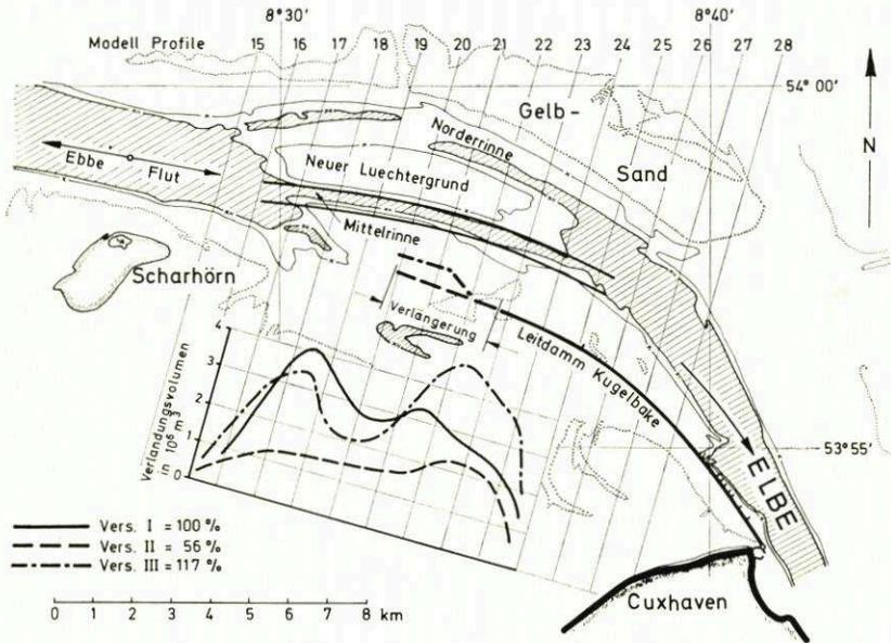
Abb. 13. Versuchsergebnisse der gemessenen Eintreibungen in die neue Mittelrinne in Bezug zu einer Verlängerung des Leitdammes
