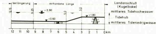
Abb. 12. Längsschnitt des Leitdammes mit Einzelheiten der Kronenform
