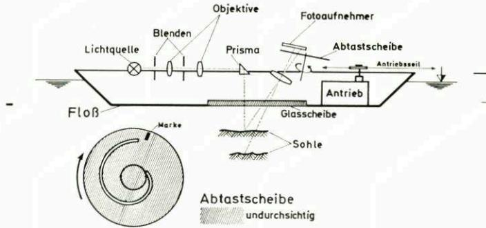
Abb. 8. Elektronisch-optisches Gerät für die Aufmessung der Morphologie
