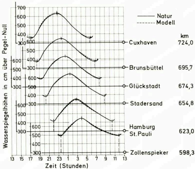
Abb. 9. Vergleich von Tidekurven im Modell und in der Natur
