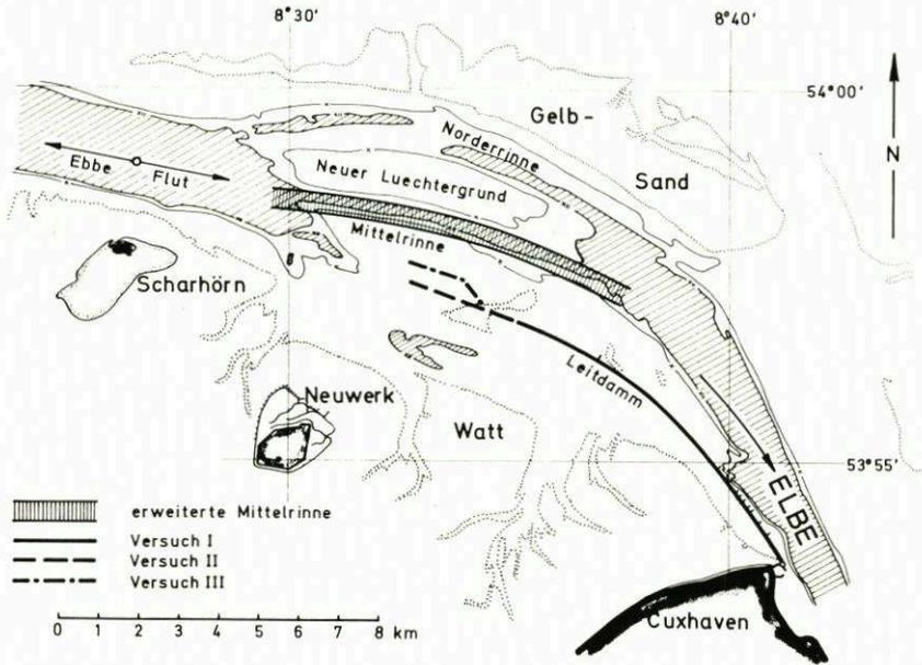
Abb. 11. Entwurfsvarianten für eine Leitdammverlängerung
