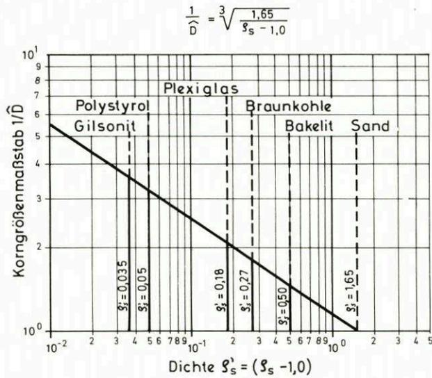
Abb. 2. Maßstabsbeziehungen zwischen der Dichte und dem Korndurchmesser des Sohlmaterials im Modell [1]
