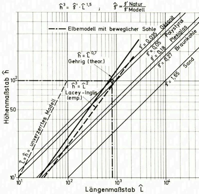
Abb. 1. Maßstabsbeziehungen für Modelle mit beweglicher Sohle [1]
