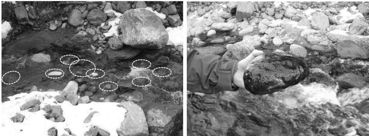
Abbildung 5: Ausgesetzte Tracersteine im Krumeegger Bach (linkes Bild), wieder gefundener Tracerstein mit Braunalge (rechts)
