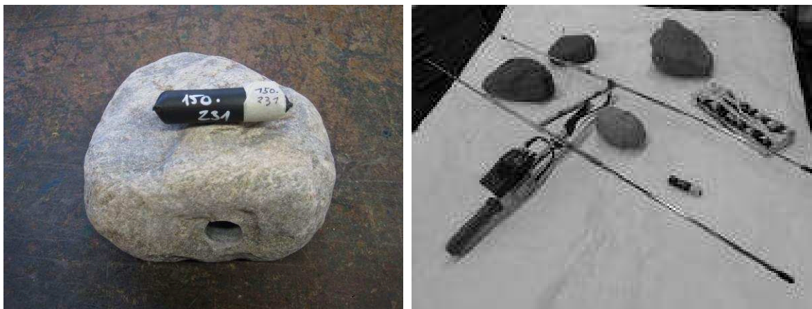
Abbildung 6: Gebohrter Naturstein mit Telemetriesensor (linkes Bild), Telemetrieantenne mit Tracersteinen (rechts)
