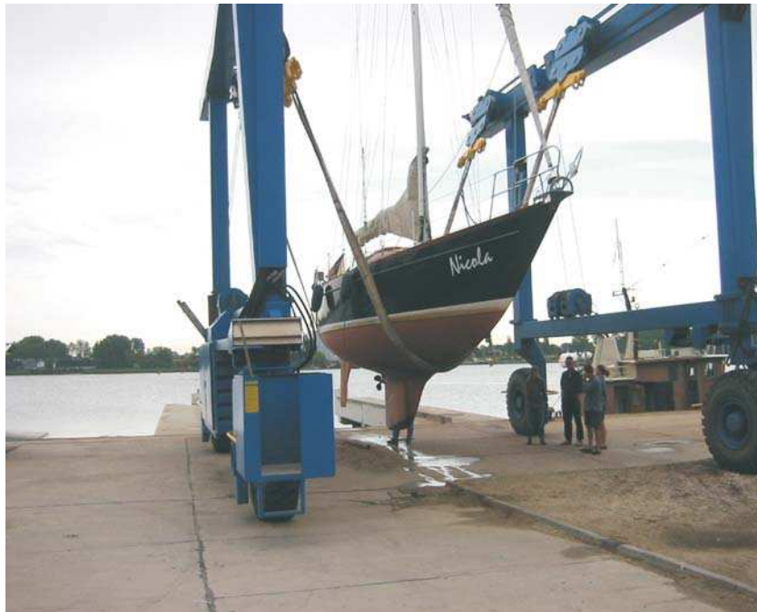
Abb. 10: Travel-Lift im Hafen Rostock-Bramow. Segelyacht „Nicola“ in Gurthalterung (Foto IWR)
