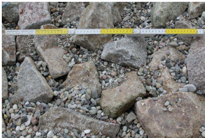
Bild 1: Modellversuch mit infiltriertem Kornfilter in Wasserbausteine CP 90/250
