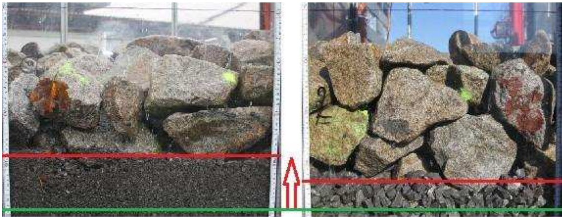
Bild 4: Vergleich Eindringtiefe des Filtermaterials, (li.) Filter 16/32 mm, (re.) Filter 2/16 mm
