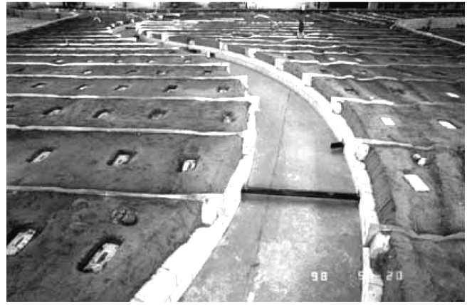
Bild 5: Blick auf das Modell im Rohbau (Umgrenzungsmauern, Blechprofile und Verfüllung im Vorlandbereich, Flussschlauch noch frei)
