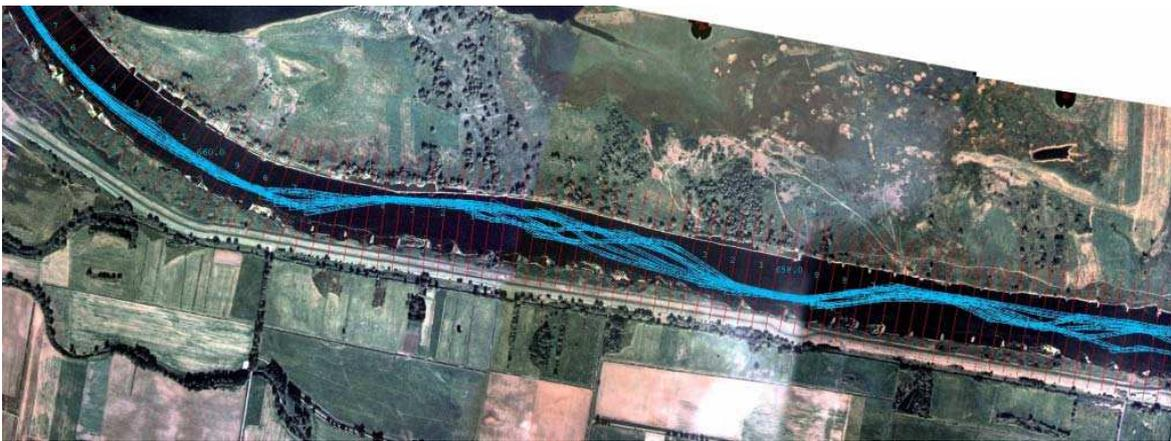
**Abbildung 8** Nautisch optimierte Fahrrinnen aus 5 unabhängigen Modellversuchen (Variante V2a)
