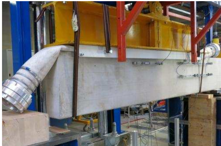
Bild 6: Aufbringen der Gleichstreckenlast auf einen Kragträger
