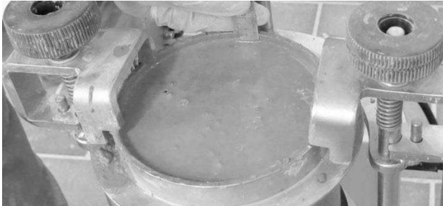
Bild 4: Absetzmaß bei einer Konsistenz des Betons von 500 mm
