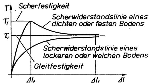
Bild 12: Scherverschiebungsdiagramm verschiedener Böden aus (Kempfert et al. 1998)
