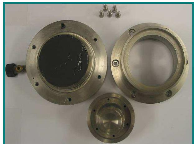
**Bild 24:** Oedometerzelle des bodenmechanischen Labors der BAW Hamburg
