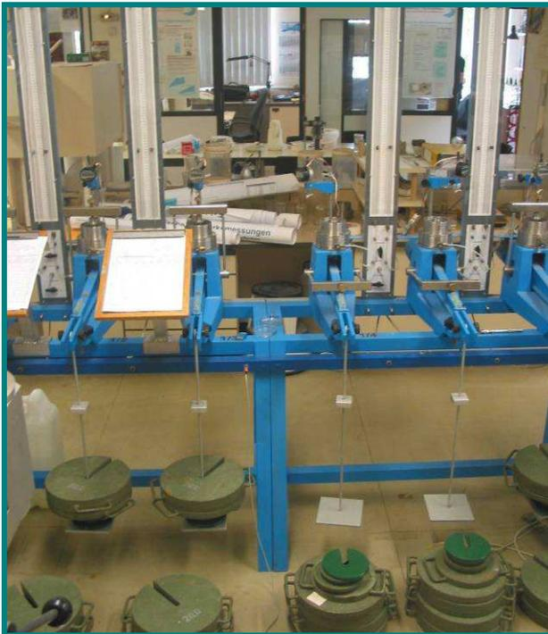
**Bild 25:** KD-Stand des bodenmechanischen Labors der BAW-Hamburg
