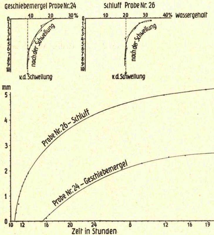
Abb. 11. Zeitlicher Verlauf der Schwellung des von Wasser überfluteten Geschiebemergels und Schluffes (unten) sowie Änderung des Wassergehaltes innerhalb der Bodenproben von Zentimeter zu Zentimeter (oben)
