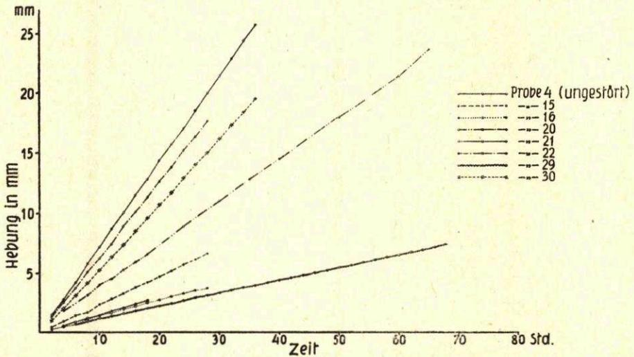
Abb. 9. Frosthebuungsverlauf ungestörter Bodenproben aus dem Brodtener Ufer (Nr. 4, 15, 16, 20, 21, 22, 29, 30)
