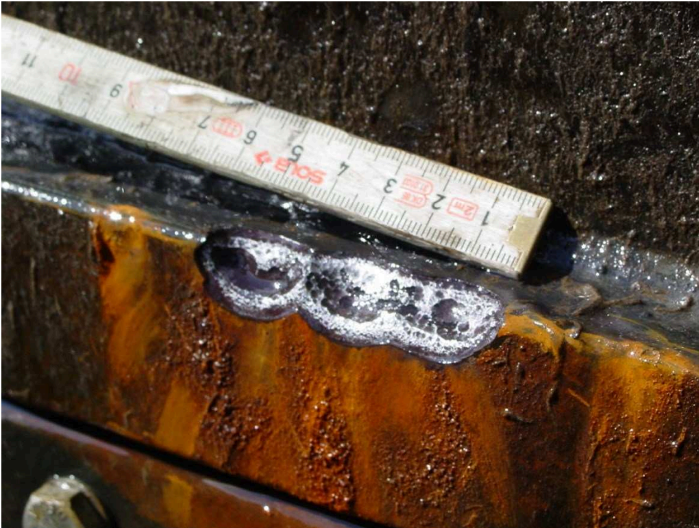
Bild 2: Lokaler MIC-Schaden mit sehr hohen Abtragsraten (etwa 1750 \mu\text{m/a} ) nach dem Öffnen der gebildeten Rostblase (Tuberkel)
