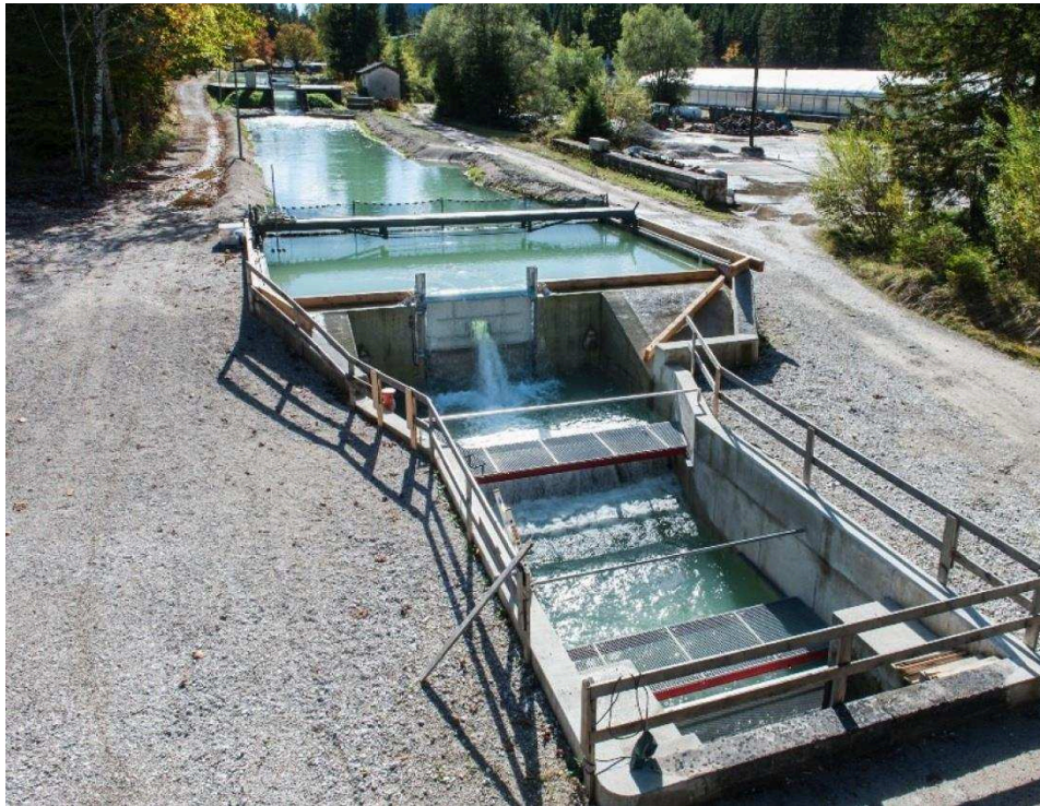
Abbildung 5: 35 kW Prototypanlage an der Versuchsanstalt in Oberrach (VAO). Die mit Netz bzw. Lochblech eingegrenzten Bereiche im Oberwasser und Unterwasser sind ersichtlich.
