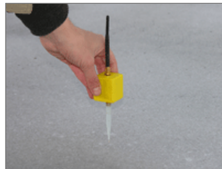
Abbildung 8: funkbasierte Kapillardrucksensoren im Einsatz
