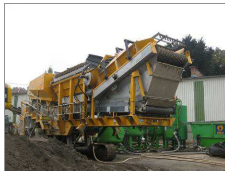
Abbildung 2: Sternsiebzanlage zur Bodenaufbereitung
