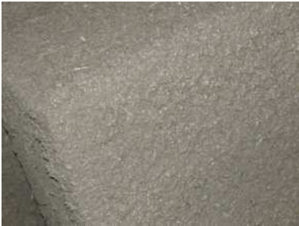
Bild B17: Nafufill GTS-HS mit AR-Glasfasern. Links: Nach dem Herstellen der Proben. Rechts: Im Rissüberbrückungsversuch
