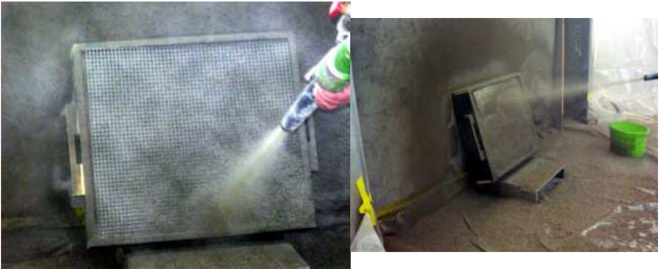
Bild B1: Herstellung der Rissüberbrückungskörper
