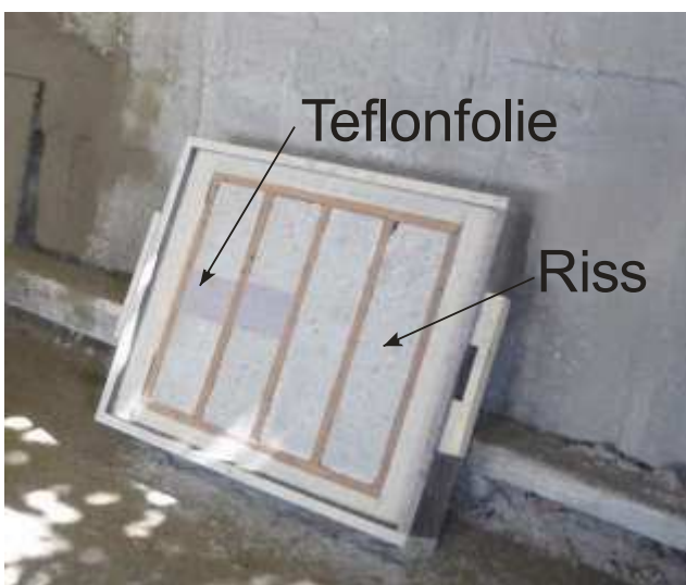
Bild B16: Links: Lokale Untergrundbehandlung im Bereich des Risses. Rechts: Nafufill GTS-HS mit AR-Glasfasern als Trockenmischung
