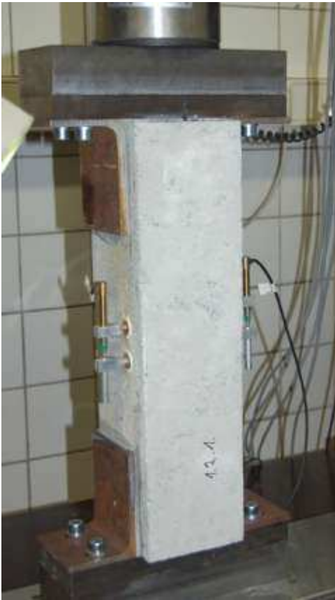
Bild B14: Links: Durchführung der Rissüberbrückungsversuche im Schritt 1. Rechts: Entstehung eines Risses oberhalb des gerissenen Altbetons (Probe 1.1.1 mit 2D-G-1200)
