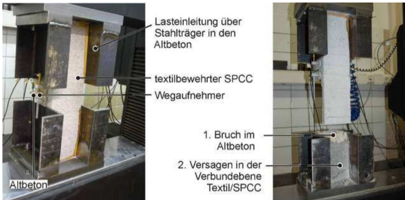
Bild 10: Links: Durchführung des Rissüberbrückungsversuchs. Rechts: Bruchbild – Zunächst trat der Bruch im Altbeton auf, dann folgte das Versagen in der Verbundebene Textil/SPCC
