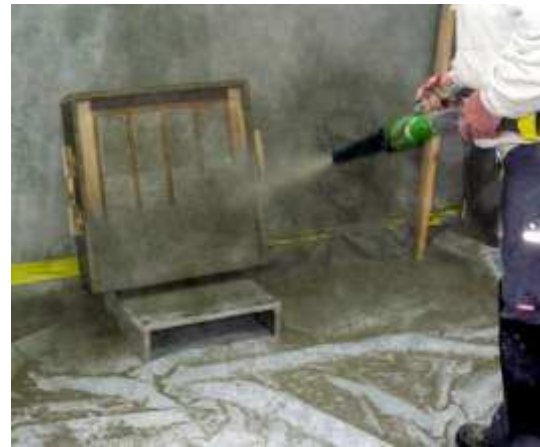
Bild 4: Links: Rissüberbrückungskörper zur Untersuchung textilibewehrter Spritzmörtel. Rechts: Herstellung der Rissüberbrückungskörper
