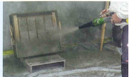
Bild 1: Links: Rissüberbrückungskörper zur Untersuchung textilbewehrter Spritzmörtel. Rechts: Herstellung der Rissüberbrückungskörper
