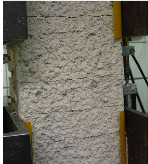
Bild 5: Links: Kräfte in der textilbewehrten Spritzmörtelschicht während der Rissöffnung des Altbetons bis zu einer Rissbreite von 0,7 mm. Rechts: Rissbild einer Probe mit AR-Glas 2D-15-09 mit EP (aus /Orlowsky 2011/)
