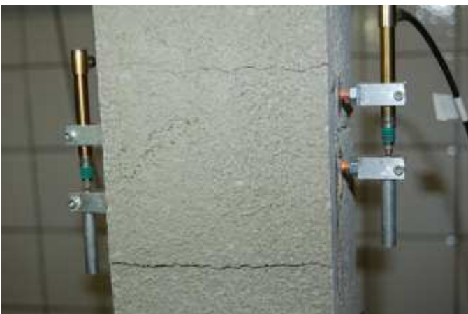
Bild B18: Nafufill GTS-HS mit 2D-C-1900 im Rissüberbrückungsversuch
