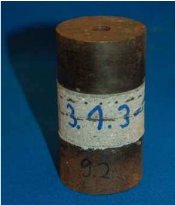
Bild 6: Zugversuche am textilbewehrten Spritzmörtel zur Bestimmung der Adhäsion zwischen Spritzmörtel und Textilien
