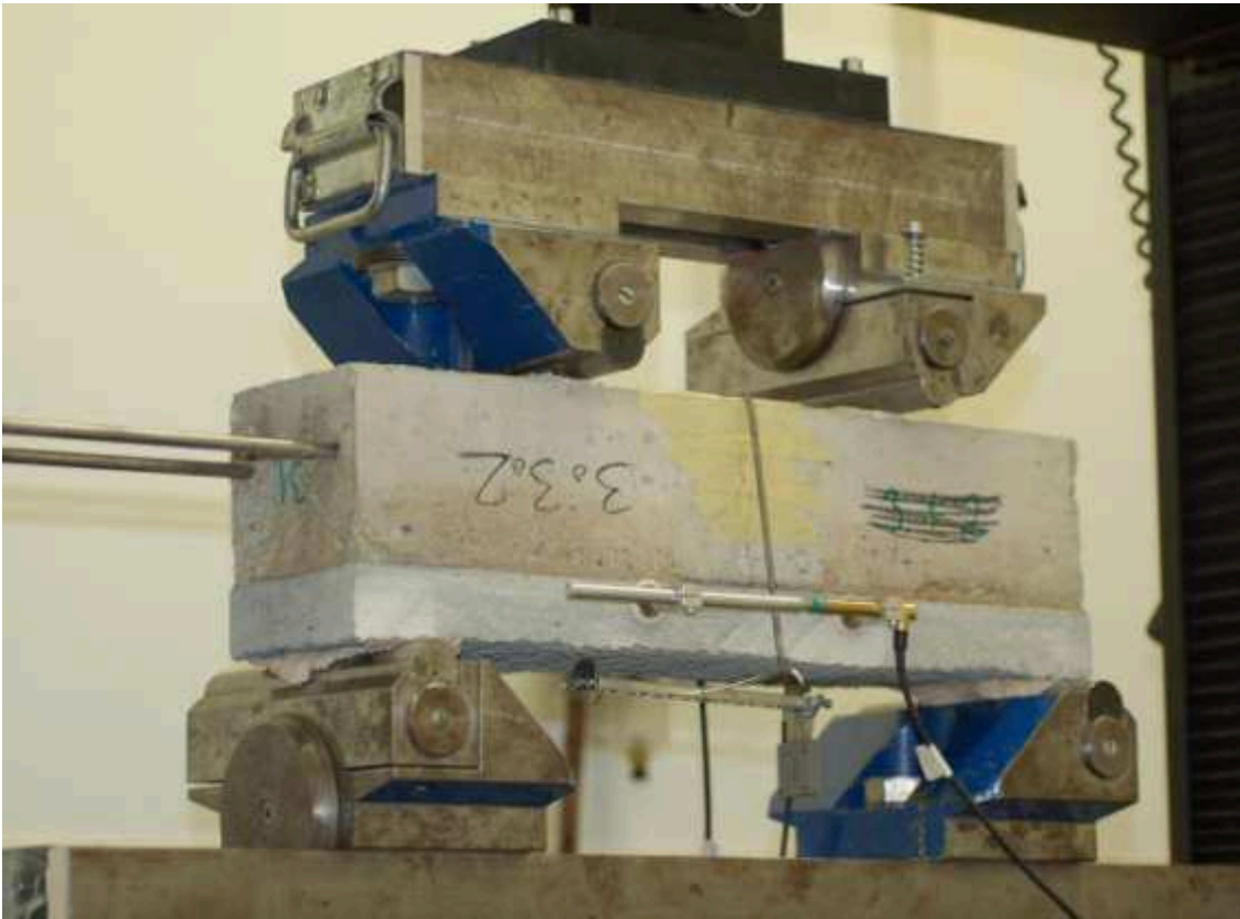
Bild 5: Biegeversuch an den Rissüberbrückungskörpern
