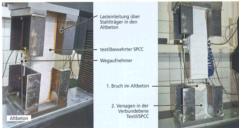
Bild 4: Links: Durchführung des Rissüberbrückungsversuchs. Rechts: Bruchbild. Zunächst trat der Bruch im Altbeton auf, dann folgte das Versagen in der Verbundebene Textil/SPCC.
