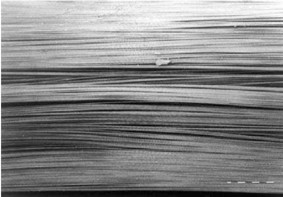
Bild 2: Filamentverteilung in einem Roving mit 2400 tex /Bra02/
