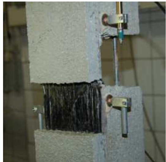
Bild B18: Nafufill GTS-HS mit 2D-C-1900 im Rissüberbrückungsversuch
