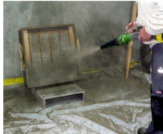
Bild 2: Links: Rissüberbrückungskörper zur Untersuchung textilbewehrter Spritzmörtel. Rechts: Herstellung der Rissüberbrückungskörper (aus /Orlowsky 2011/)
