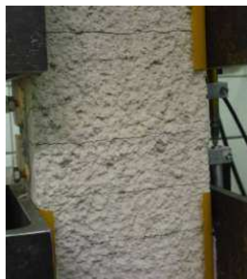
Bild 11: Links: Kräfte in der textilbewehrten Spritzmörtelschicht während der Rissöffnung des Altbetons bis zu einer Rissbreite von 0,7 mm. Rechts: Rissbild einer Probe mit AR-Glas 2D-15-09 mit EP
