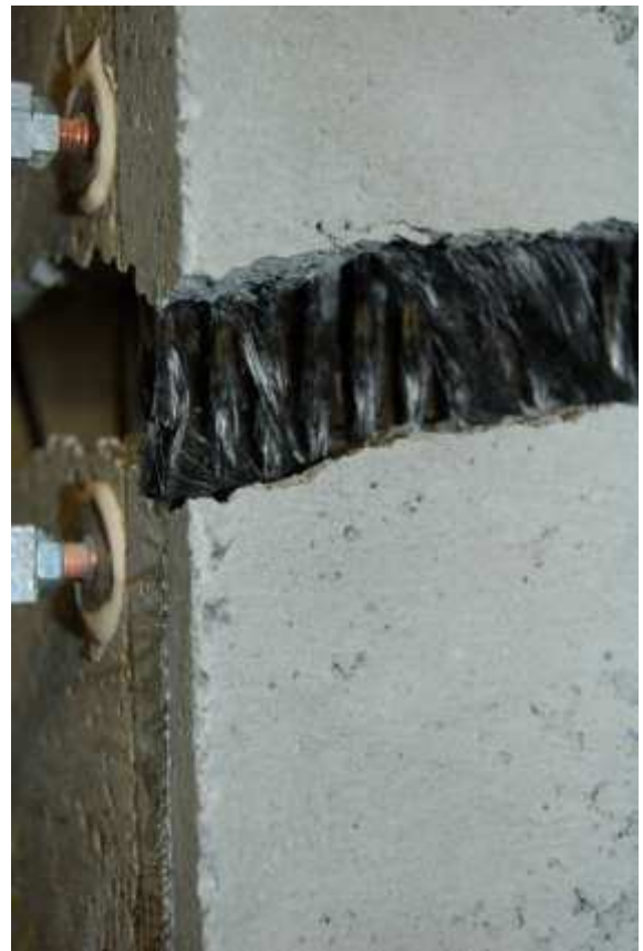
Bild B15: Probe 1.2.1 mit 2D-C-1600. Links: Riss gerade entstanden. Rechts: Herausziehen der Carbonbewehrung
