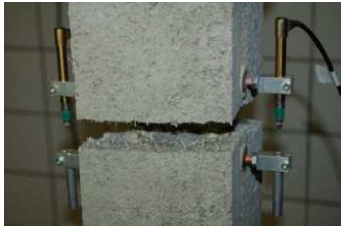
Bild B17: Nafufill GTS-HS mit AR-Glasfasern. Links: Nach dem Herstellen der Proben. Rechts: Im Rissüberbrückungsversuch
