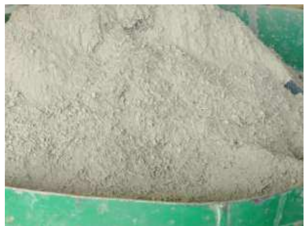
Bild B16: Links: Lokale Untergrundbehandlung im Bereich des Risses. Rechts: Nafufill GTS-HS mit AR-Glasfasern als Trockenmischung
