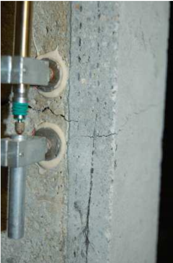
Bild B15: Probe 1.2.1 mit 2D-C-1600. Links: Riss gerade entstanden. Rechts: Herausziehen der Carbonbewehrung
