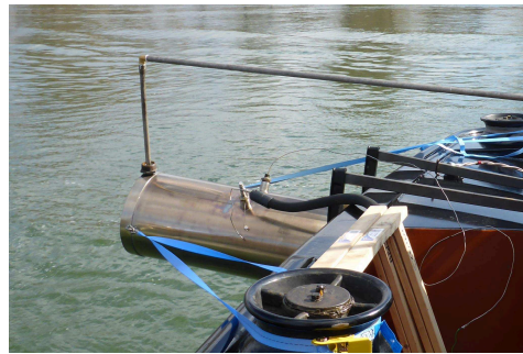
Abb.1: Abgasendrohr mit angebrachtem Kaminaufsatz für das Einbringen der Messsonden in den Abgasstrom
