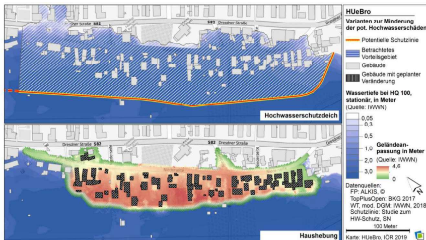
Abbildung 3: Zentrale Untersuchungsvarianten zur Minderung potentieller Hochwasserschäden in Brockwitz auf Grundlage der hydrologischen Analysen durch IHM sowie der hydronumerischen Modellierung durch IWWN
