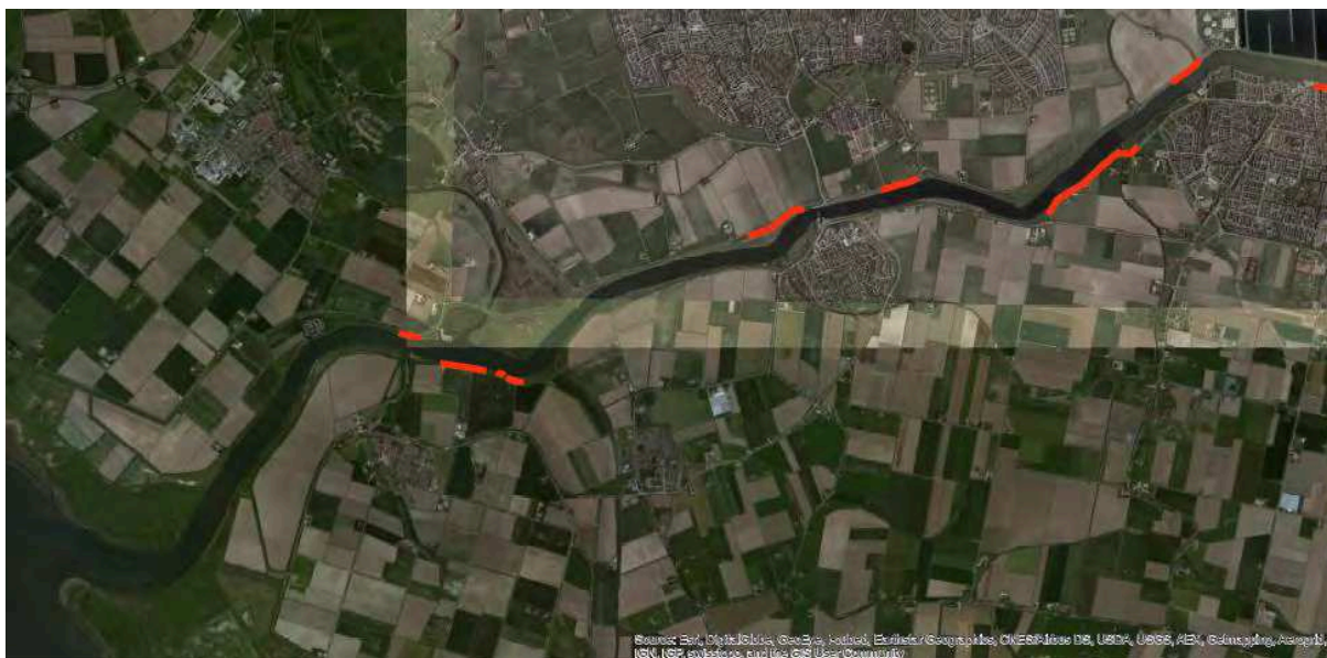
Abbildung 7 Beispielergebnisse einer Karte zur Analyse von Fließbrutschungsabschätzungen
