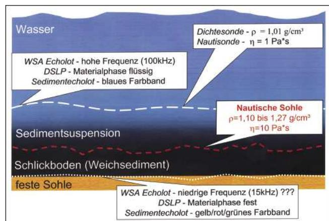
Bild 6: Definitionen zur Nautischen Sohle aus geotechnischer Sicht
