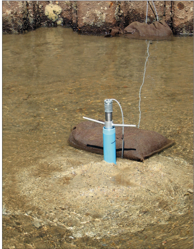
Bild 8 Messsystem bestehend aus Datenlogger und Packer (links) und eingebautes Messsystem (rechts) Figure 8: Measuring system consisting of data logger and packer (left) and installed measuring system (right)
