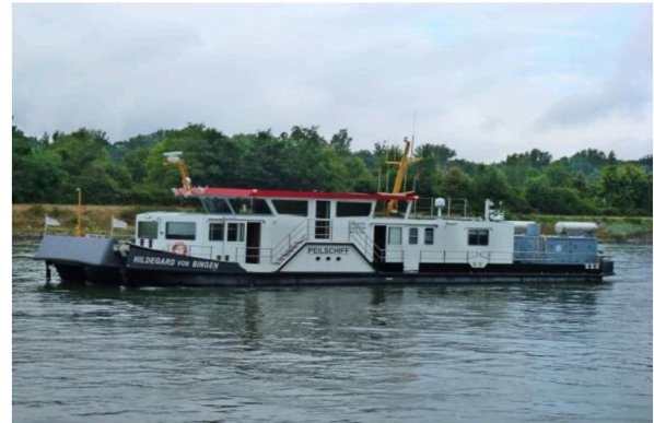
Bild 2: Fächerecholotpeilung mit Peilschiff
