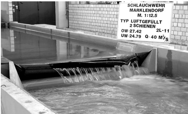
Bild 4.5: Modell des Schlauchwehrs Marklendorf/ Aller
