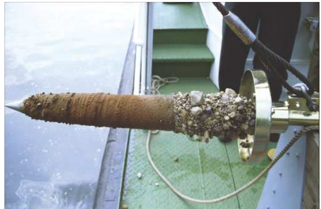
Bild 2.2: Frostkörper aus anstehendem Fein-Mittelsand und Mischkornfilter
