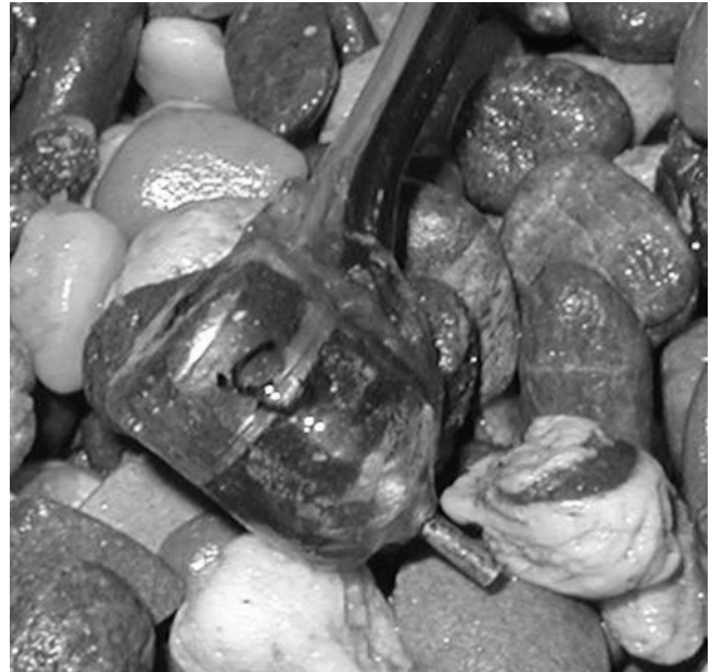
Bild 6.11: Mikrodrucksensor auf der Kiesschicht, d_{50} = 10 \text{ mm}
