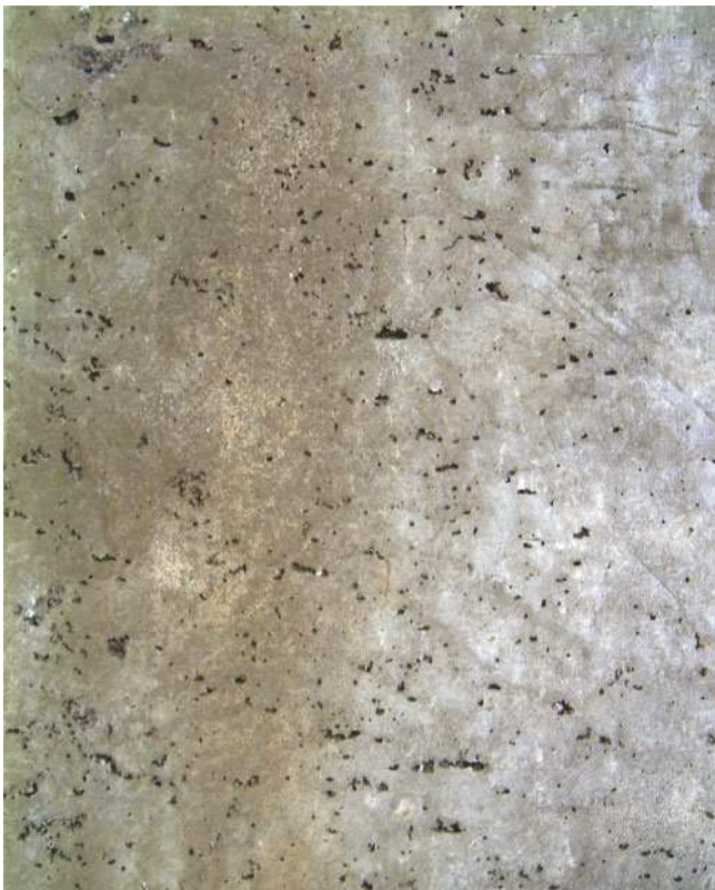
Bild 6.4: Versuchsfläche mit Lunkern
