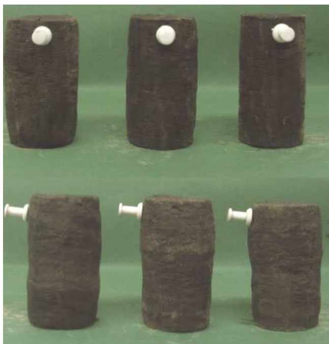
Bild 2.24: Probekörper nach Triaxialversuch (oben = horizontale Probe / unten = vertikale Probe)
