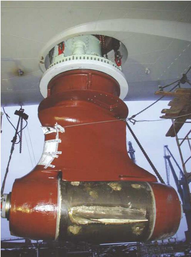
Bild 4.16: Vergleichbarer POD-Antrieb, SEP2 (ohne Propeller)
