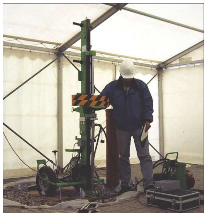
Bild 2.3: Rammsondierung im Sondiersilo
