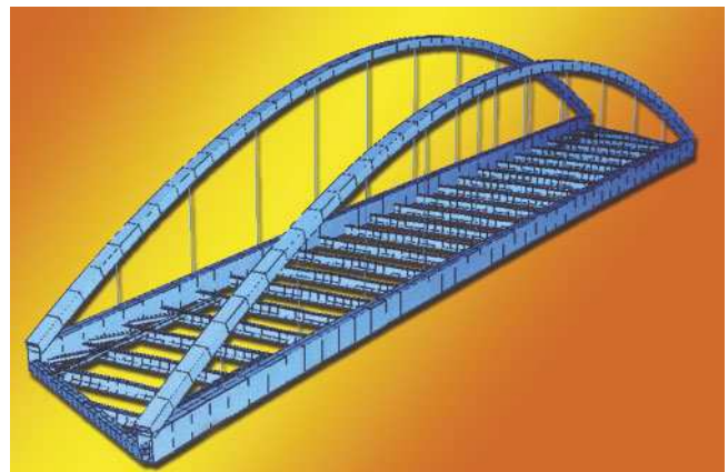
Bild 6.1: Räumliches FE-Modell der Stabbogenbrücke (Schrägsicht ohne Fahrbahnplatte)
