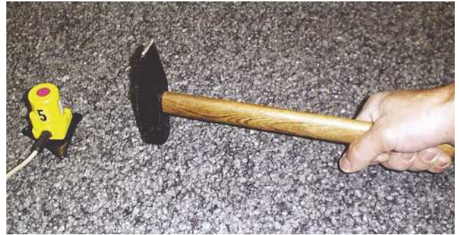
Bild 2.29: Schwingungsaufnehmer zur Messung der Stoßanregung und des Ausschwingvorgangs
