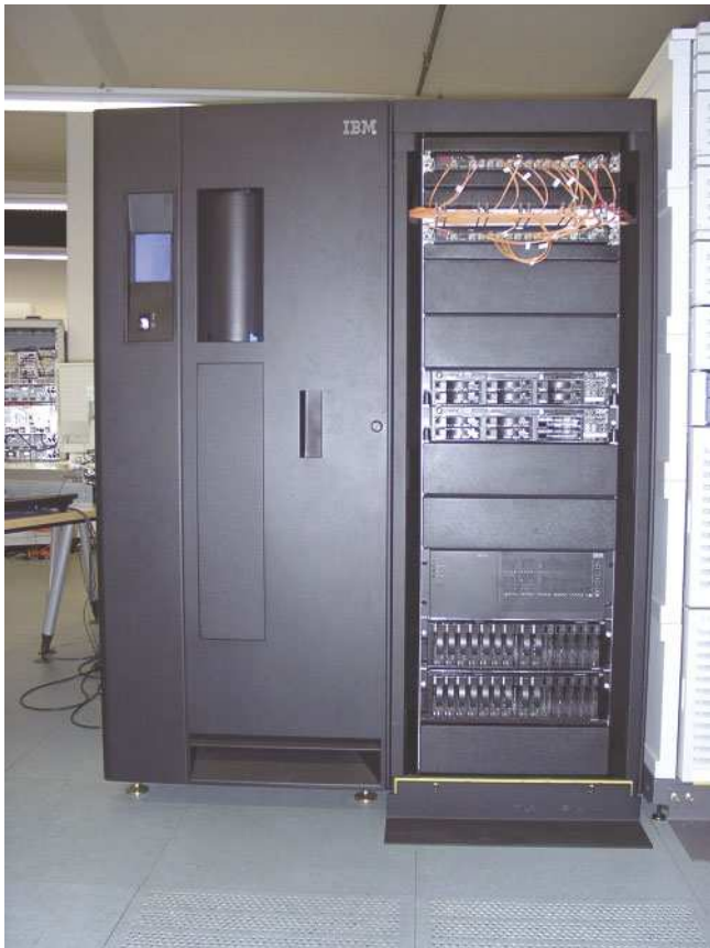
Bild 5.12: Ansicht des neuen Systems, bestehend aus dem Bandroboterschrank (links) und dem Serverschrank mit Fibre-Channel-Switches (oben rechts), Backup- und HSM-Server (Mitte rechts) und dem Plattencontroller mit den Plattengefäßen (unten rechts).
