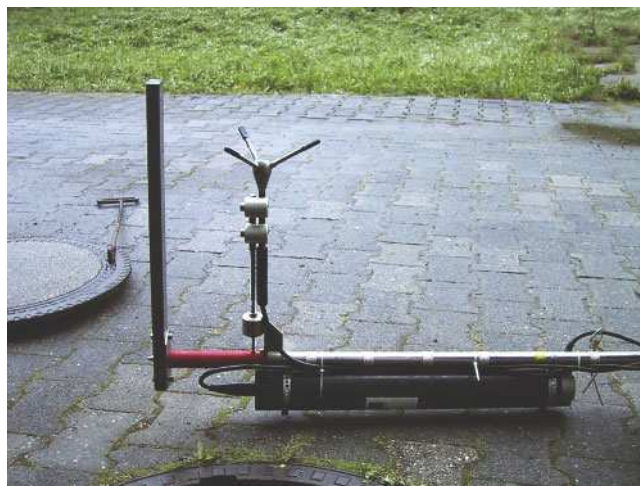
Bild 2.13: Ultraschallmesssonde zur Strömungsmessung im Dränagesystem
