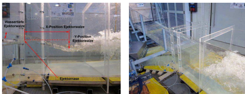
Abbildung 3: Links: Seitenansicht der Ejektorwalze mit charakteristischen Abmaßen Rechts: Blick auf den Modellprüfstand im Betrieb mit aktiviertem Ejektor
