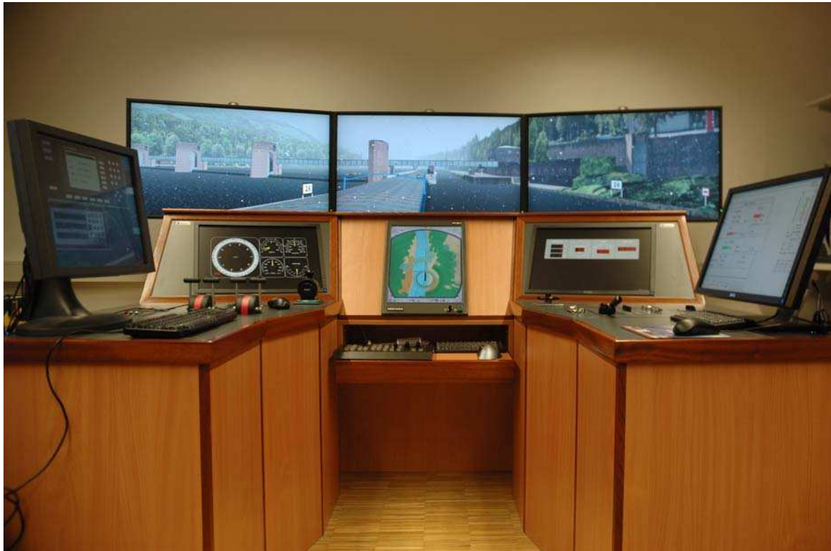
BAW-Schiffsführungssimulator ANS 5000 am Standort Karlsruhe.
