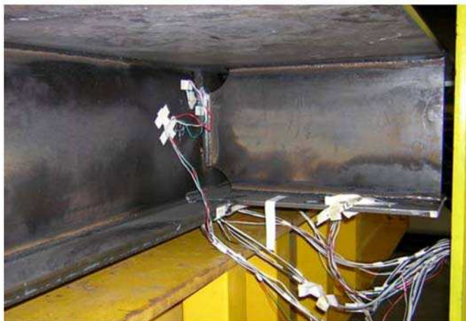
Bild 4: Bauteilversuch Kerbdetail 1 und Lastbild für die Bauteilversuche
