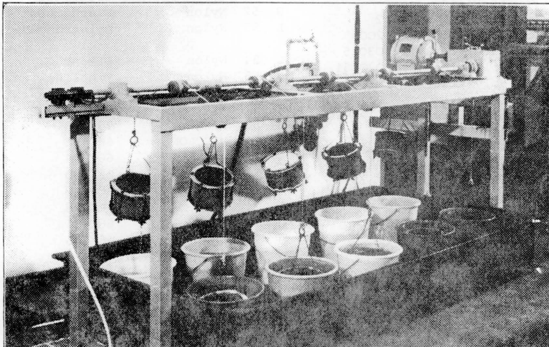
Abb.12 Vorrichtung für die Prüfung der Filterwirksamkeit
