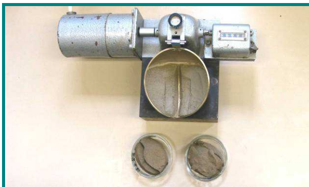
Bild 7: Fließgrenzengerät nach Casagrande
