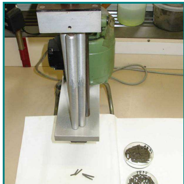
Bild 8: Gerät zur Bestimmung der Ausrollgrenze
