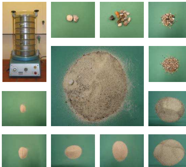
Bild 1 Siebung – Siebmaschine und Kornfraktionen
