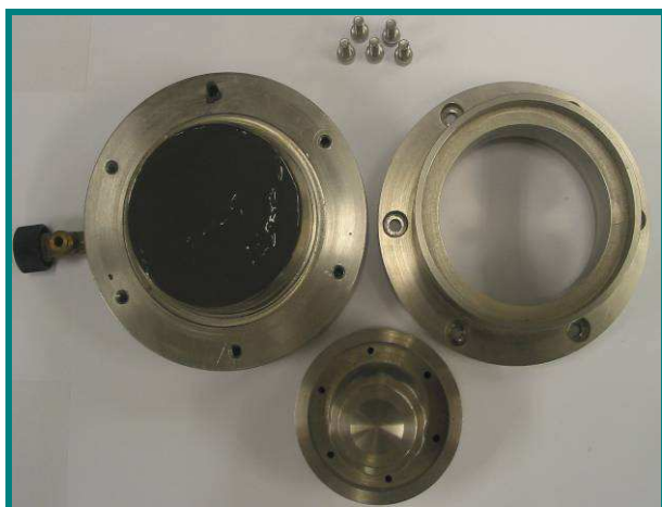
Bild 24: Oedometerzelle des bodenmechanischen Labors der BAW Hamburg
