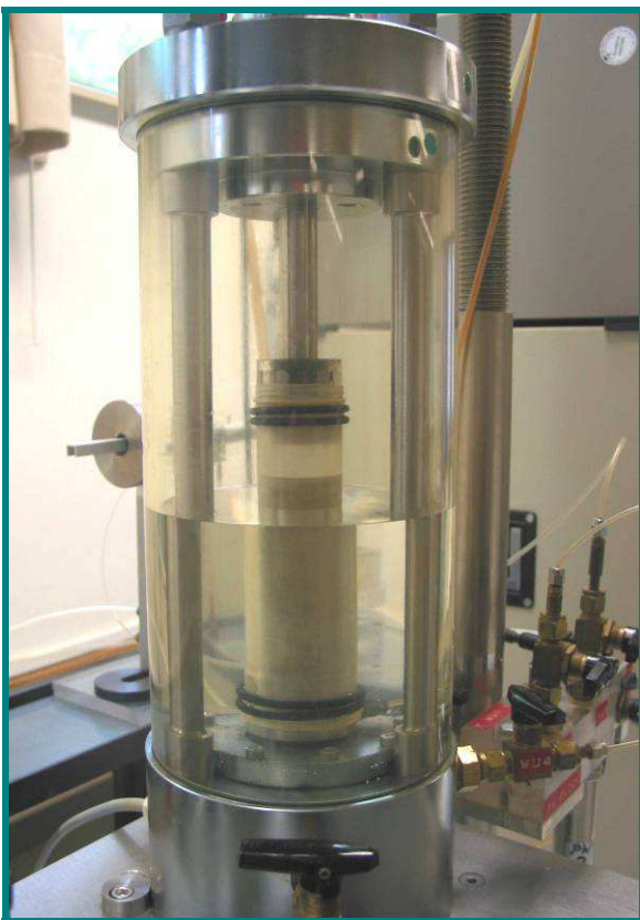
Bild 15: Triaxialprobe in der Zelle (Standard-triaxialgerät der BAW-DH)
