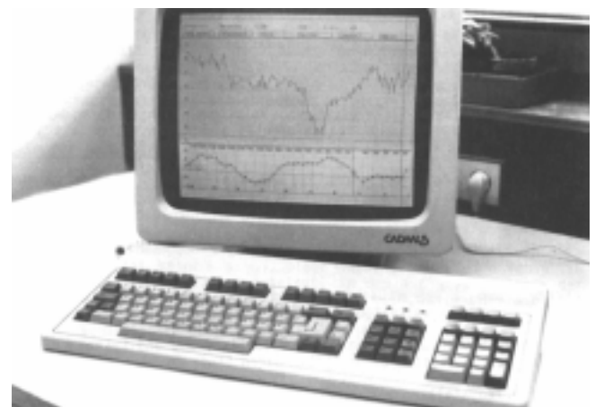
Bild 5: Querprofilbearbeitung am Grafikschiem; auf dem Grafikschiem wird hier ein Querprofil und gleichzeitig die Fahrtroute des Peilschiemes (im unteren Drittel angezeigt)
