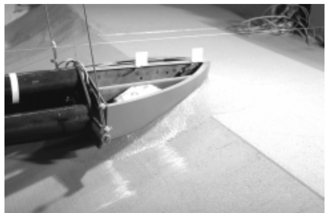
Bild 4: Modellversuch (Maßstab 1 : 23) zum Schiffsaufprall auf eine Erdböschung
