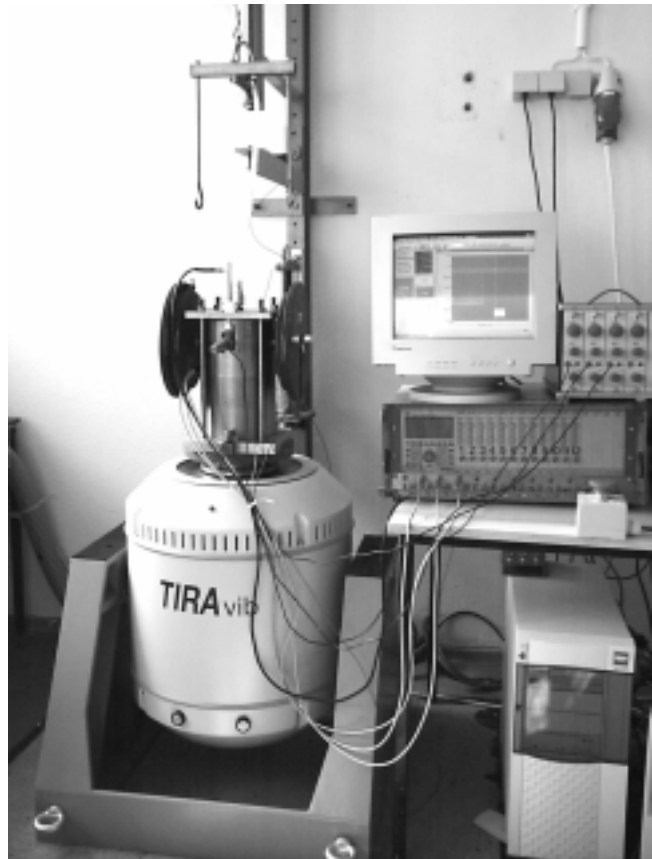
Bild 3: Schwingungsprüfstand mit dynamischem Ödometer zur Untersuchung des Setzungsverhaltens von Bodenproben bei Schwingungsbeanspruchung
