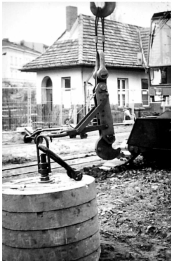
Bild 1: Fallgewicht (2,5 t) mit Auslösevorrichtung zur stoßartigen Anregung des Baugrunds, hier auf dem Gelände der alten Schleuse Spandau
