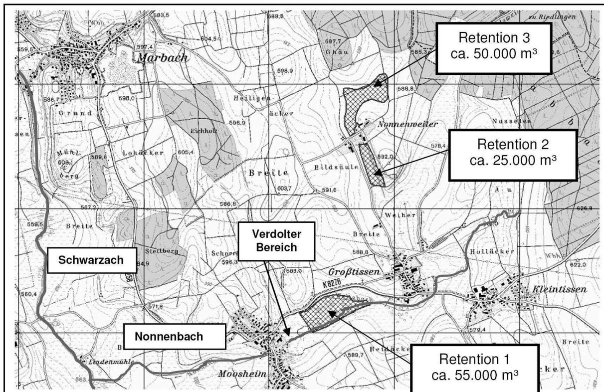
**Abbildung 2:** Mögliche Retentionsräume zur temporären Speicherung von Oberflächenabflüssen sowie weitere Angaben zur örtlichen Situation
