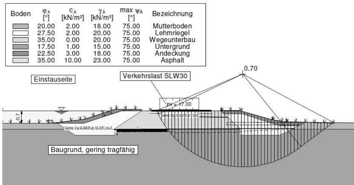
**Abbildung 5:** Böschungs- und Geländebruch; der höchste Ausnutzungsgrad errechnet sich bei Überströmung und Verkehrsbelastung zu  $\mu = 0,7$ , BS-A.
