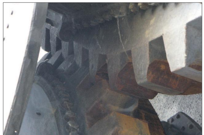
Bild 7: Plastische Verformungen der Zahnschiene und der Zahnkränze an der Versenkwalze der Mainstaustufe Viereth (Braun, 2009 und 2011)
