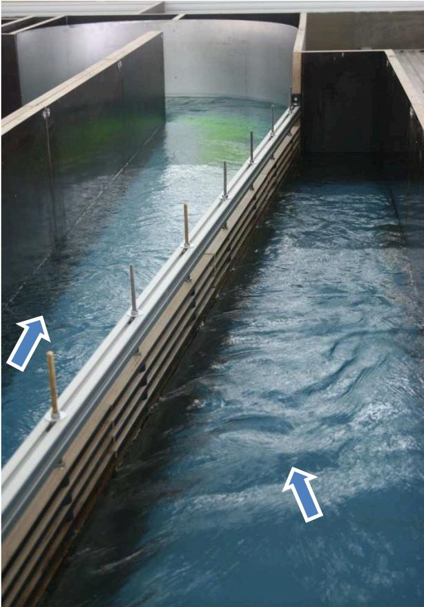
*Bild 2: Gegenständliches Modell an der BAW zum Einleitungsbereich der Dotationswassermenge in einen Fischpass.*
