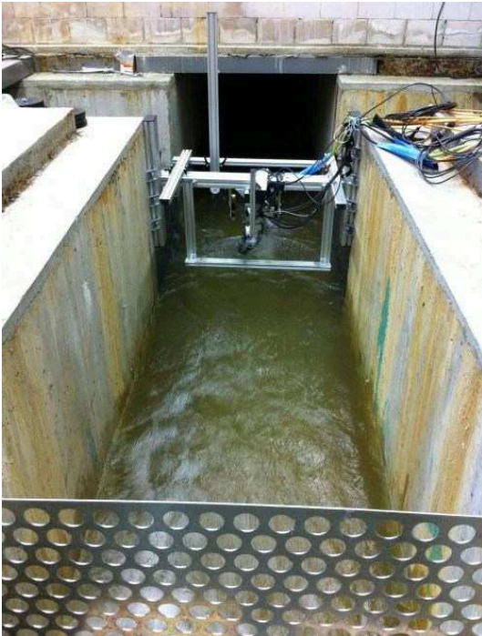
Bild 20: Durchgeströmte Rinne und Schwanzflossenantrieb [6, S.282].
