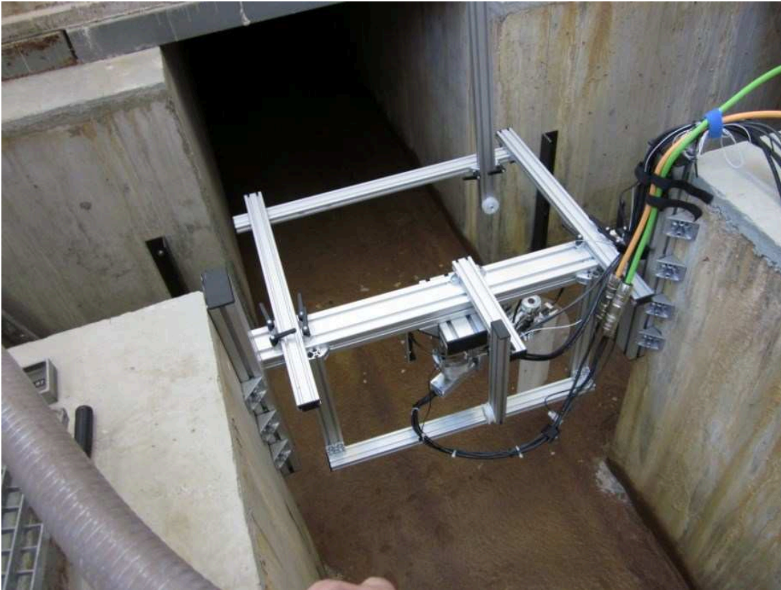
Bild 26: Befestigung des SF-Antriebes in der Tiefrinne.
