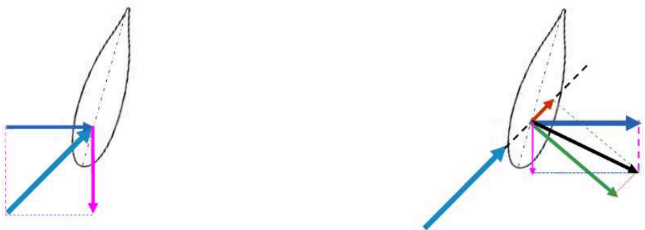
Bild 10: Bremswirkung eines Schlagflächenantriebs
