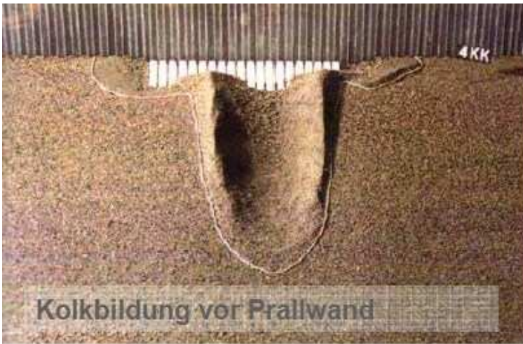
Bild 3: Kolkbildung vor Prallwand [3, S.6].
