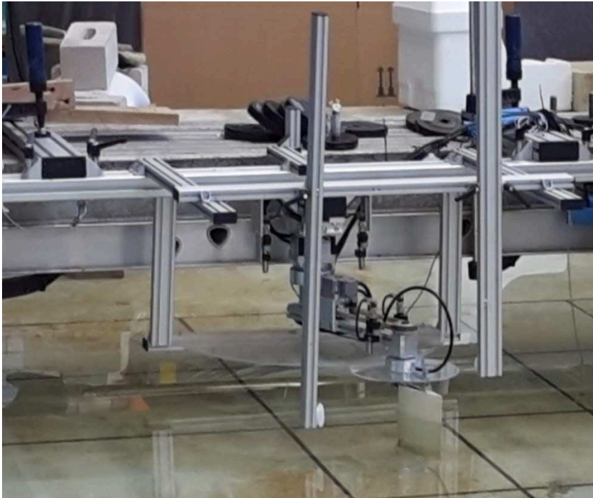
Bild 39: Aufbau des Versuchstandes im ruhenden Wasser.
