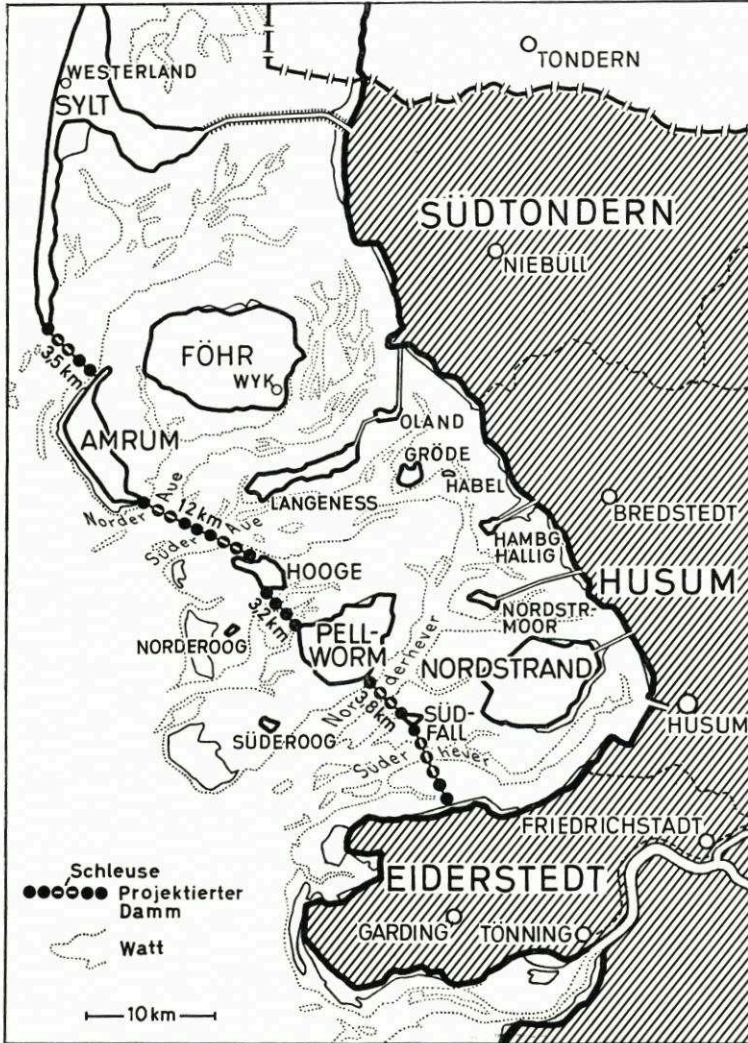
Abb. 9. Der projektierte Damm zwischen der Insel Sylt und Eiderstedt (Dix-Plan)
