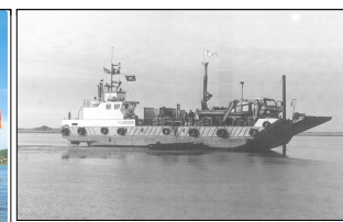
Bild 3: Drucksondierungen auf dem Wasser
