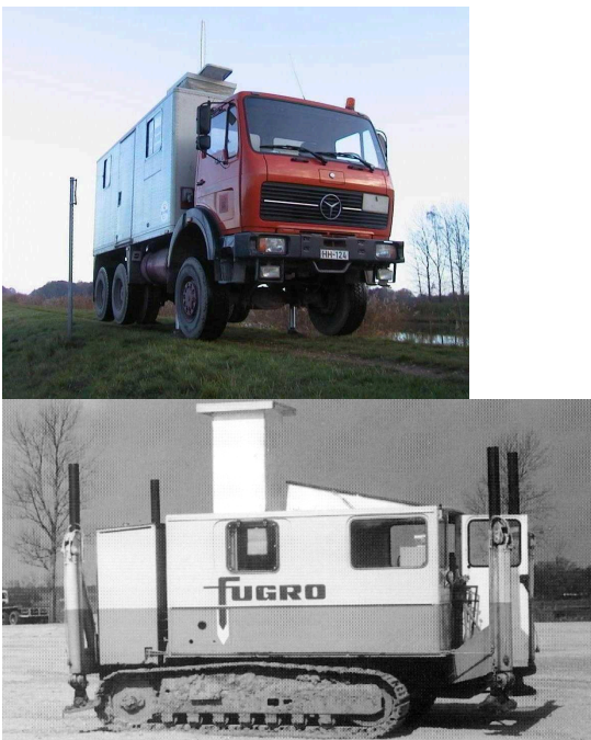
Bild 2: Sondiergeräte für Drucksondierungen an Land
