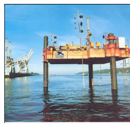
Bild 3: Drucksondierungen auf dem Wasser
