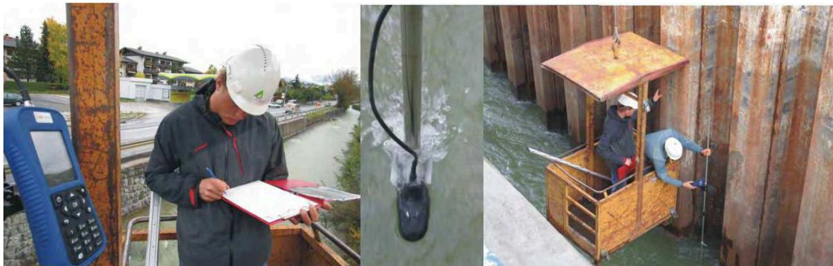
**Abbildung 6:** Fließgeschwindigkeits- und Abflussmessung mit dem MF-PRO [Ott]
