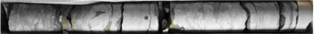
Bild 3: Kalkstein aus dem Oberen Muschelkalk (Geotechnischer Bericht Schleuse Kochendorf des ELE von 2011)
