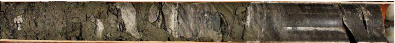
Bild 6: Teilweise ausgelaugter Gips der Oberen Sulfatschichten
