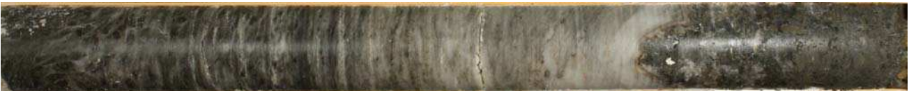
Bild 5: Kompakter Gips der Oberen Sulfatschichten mit Tonsteineinlagerungen
