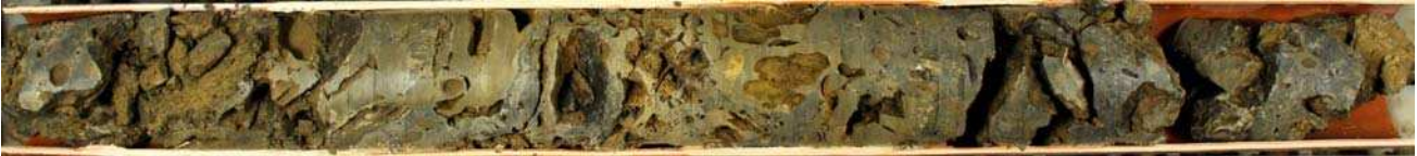
Bild 4: Kavernöser Dolomitstein aus dem Lauffen-Horizont
