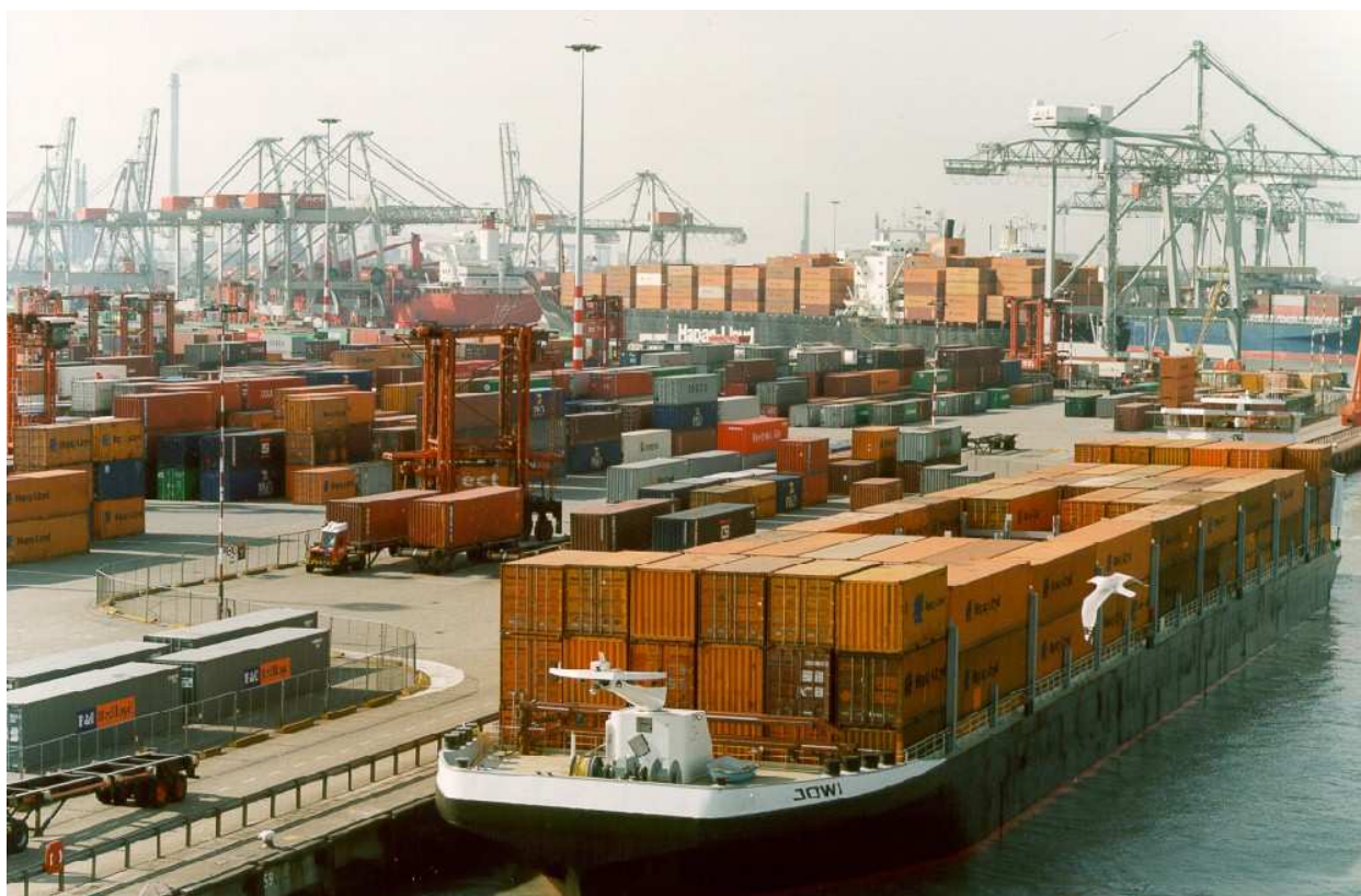
Binnen-Containerschiff "Jowi" - Länge 135 m - Breite 16,90 m - 470 TEU - (Foto: Europe Container Terminals - Rotterdam)
