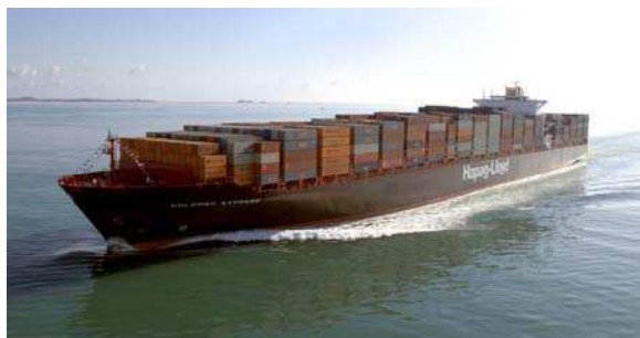
CMS "Colombo Express" - Länge 335 m - Breite 43 m - Baujahr 2005 - - Tragfähigkeit 104.000 t - 8.750 TEU - (Foto: Hapag-Lloyd - Hamburg)
