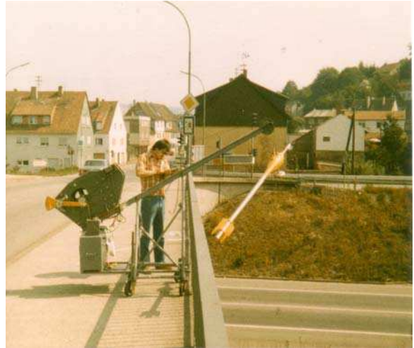
Brückenmesswagen im Einsatz auf der Straßenbrücke in Gündingen
