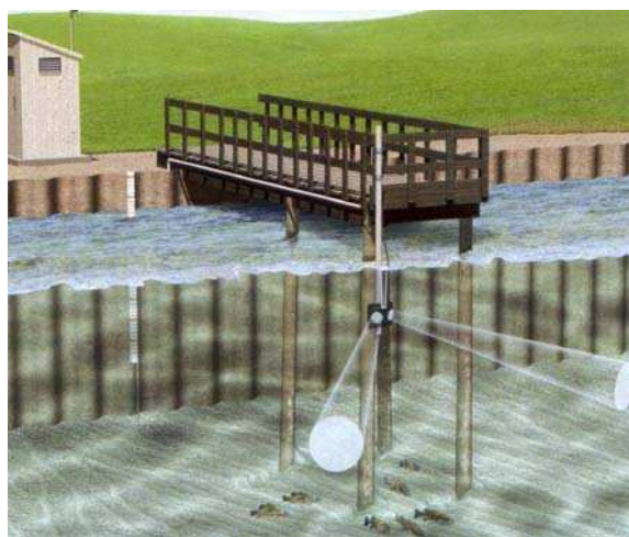
Prinzipische Skizze einer Horizontal Doppleranlage (H-ADVM) (Quelle: Son Tek)
