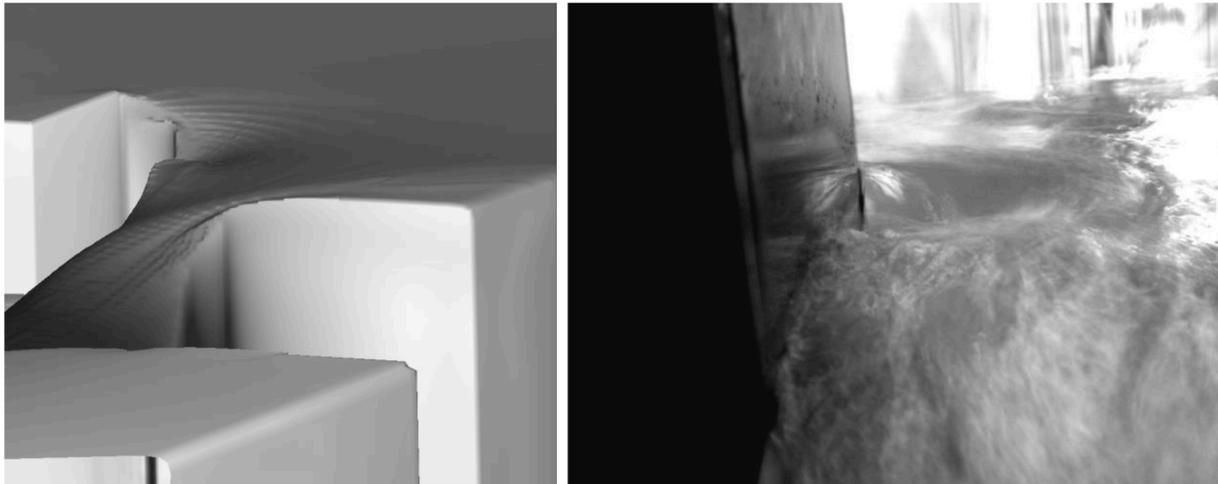
**Abbildung 4:** Der Absink an der Leitwand wird naturgetreu simuliert; links: Simulationsergebnis, rechts: Labormodell
